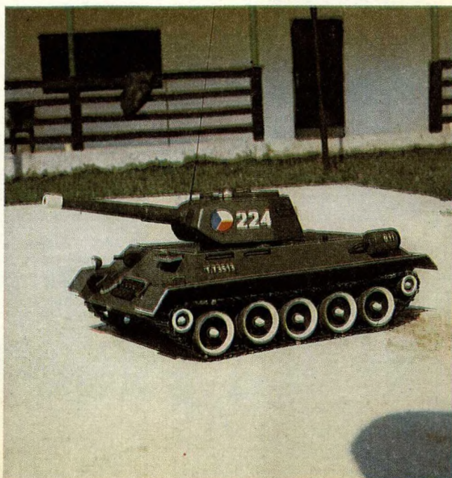
▼ Podle skutečného tanku, vystaveného v Klatovech, zhotovil RC polomaketu T-34 Jan Kubička z LMK Strakonice. Model v měřítku 1 : 8 o hmotnosti 18 kg má ovládaný směr a smysl jízdy, otáčení věže a střelbu z kanónu
