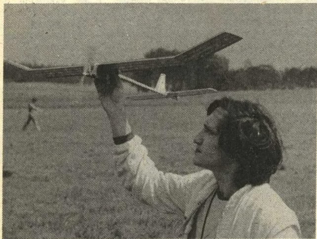
Jiří Tábořský létal s osvědčeným soutěžním modelem, potaženým tenkou pokovenou plastickou fólií
