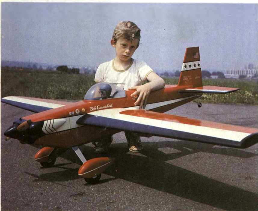
▲ Maketa letounu Laser 200 F, na němž startoval na MS 1978 v letecké akrobacii na Hosíně Bob Carmichael, má v měřítku 1:4 rozpětí 1850 mm, hmotnost 4100 g a pohání ji motor OS Max 10 cm 3 . Jan Kozák z Prahy ji řídí soupravou Modela 6 AM27
