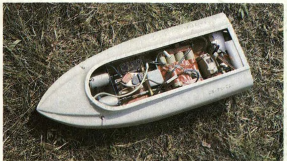
▼ Pavel Ševčík z Ostravy soutěží s laminátovou slalomkou poháněnou dvojicí motorů Mabuchi 540, napájených devíti NiCd akumulátory Varta
