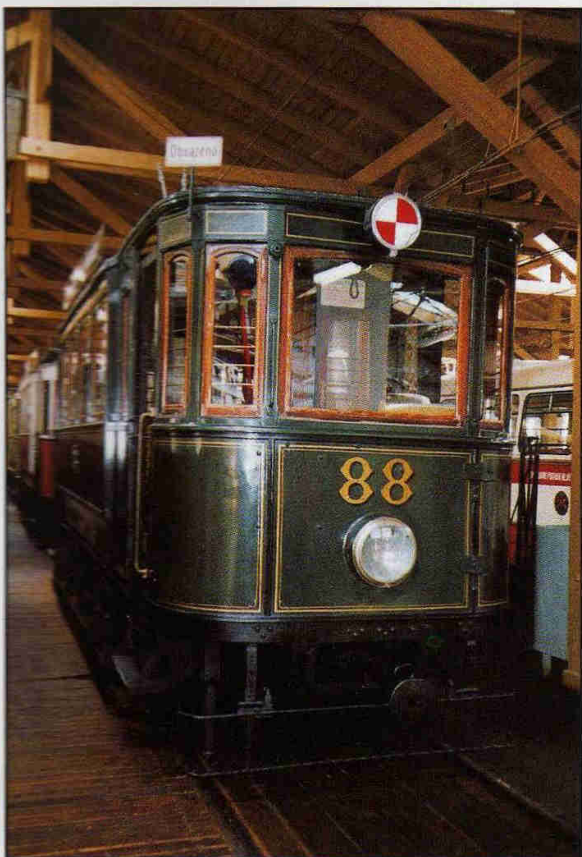
Motorový vůz č. 297 z roku 1909 postavila firma Ringhoffer Praha, elektrickou výzbroj dodala firma Křížník. Tyto „motoráky“ používaly jako vlečné vozy tzv. „velký vamberák“ (1908) a „malý vamberák - vajíčko“ (1909), se kterými tvořily třívozovou soupravu, typickou pro pražskou dopravu z konce 40. let.
