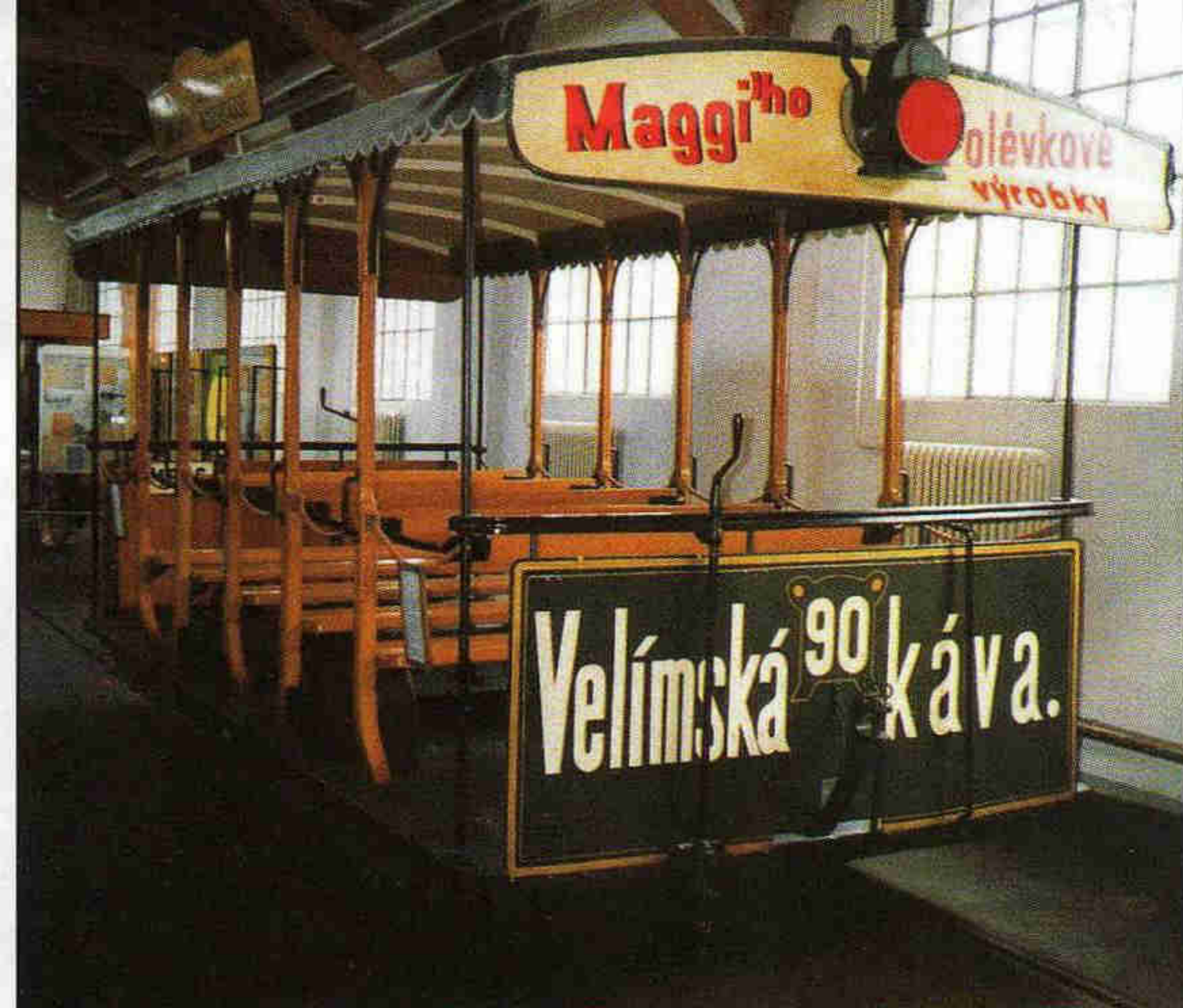
Nejstarším historickým vozidlem střešovického muzea je letní vůz koňské dráhy z roku 1886. Vlečný vůz o hmotnosti 1500 kg, který byl vybaven jednoduchým dvounápravovým podvozkem, vyrobila firma Ringhoffer Praha (pozdější Tatra Smíchov). Provoz městské koňky byl v Praze zahájen roku 1875 na lince Karlín - Národní divadlo.
