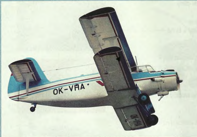
▲ S vlastnoručně postaveným modelem dvouplošníku Antonov An-2 o rozpětí 2160 mm, délce 1500 mm a hmotnosti 5500 g, poháněným motorem MVVS 12,7 cm 3 , létá Rudolf Kraina s LMK Máj Karvina. RC soupravou Varioprop ovládá, směrovku, výškovku, motor, křídélka a výsadek parašutisty
