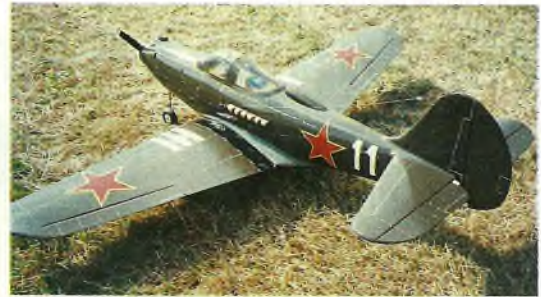
P-39 Airacobra Radima Hovorky ze stavebnice firmy Aircraft model má kromě základních funkcí a vztlakových klapek ovládn i zážeh dýmovnice pro imitaci sestřelu
