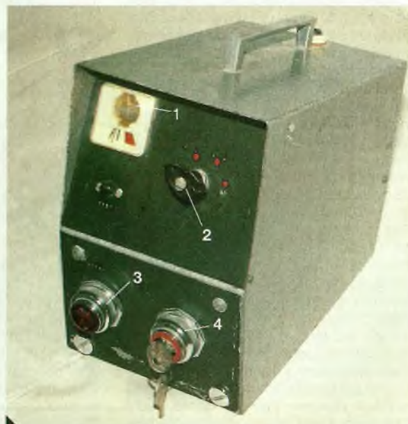
Obr. 9 Odpalovací skřínka modelů raket: 1 kontrolka uzavřeného obvodu, 2 přepínač pro jednotlivé rampy, 3 tlačítko Start, 4 hlavní (blokovací) vypínač
