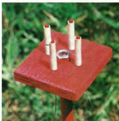
Obr. 7 Při startu vícemotorových modelů je vhodné použít podpěrný stojánek
