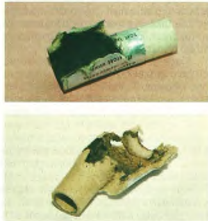
Obr. 3 K havárii motoru může dojít i v případě, že plášť pevnostně nevydrží namáhání
