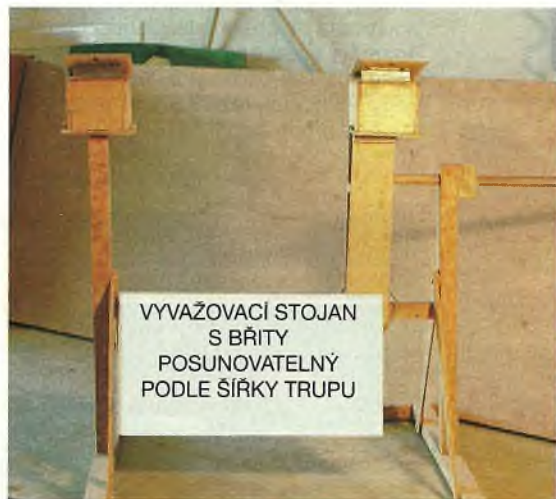
Snímkem posuvného stojanu na kterém vyvažujeme model s dočasně nelepenými břity se vracíme k předchozímu pokračování
