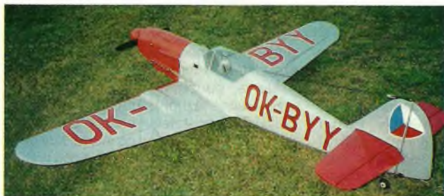
Policejní Avia S-199 Pavla Kukly ze stavebnice firmy VL model je poháněna motorem MVVS 12,7 cm 3 a kromě základních funkcí má ovládnuty vztlakové klapky
