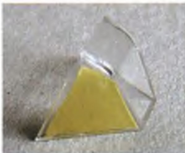
3 Prakryt kabiny s plochou chráněnou před barvou maskou vyřezanou z pásky Tamiya
