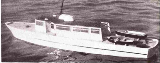
M. Mrázek z Hulína (Leninova 934) řídí svou jachtu Polly R/C soupravou Beta. Pohon je dvěma motory 12 V, zdroje olověné akumulátory
