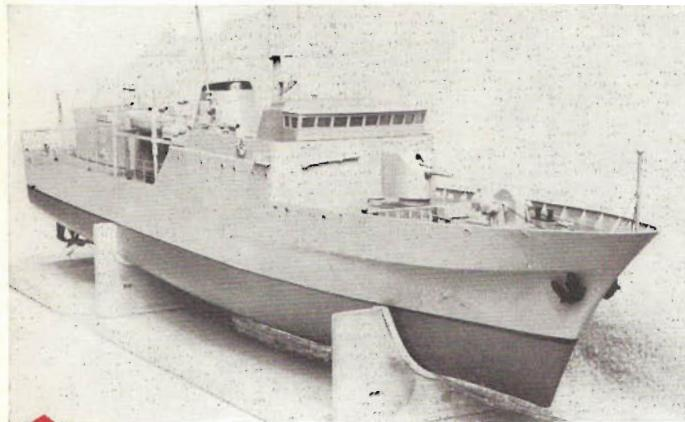
Maketu doprovodného člunu TOBRUK zhotovili A. Varga a F. Bohúš v kroužku při ODDM Galanta. Model v měřítku 1:50 je dlouhý 1080 mm. Pohánějí jej dva motory Igla 4,5 V, napájené akumulátorem 6 V. Amatérská RC souprava ovládá kormidlo, chod motoru vpřed i vzad a bzučák
