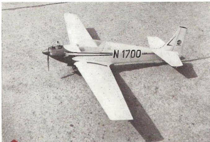
RC maketa RF 4D je novinkou J. Bílého z Mělníka. Rozpětí 1700 mm, váha 1800 g, motor MVVS 2,5 TR; řízena obě kormidla a plyn. (Hydroplán téhož konstruktéra – viz MO 9/69 – vydáme, pozn. red.)
