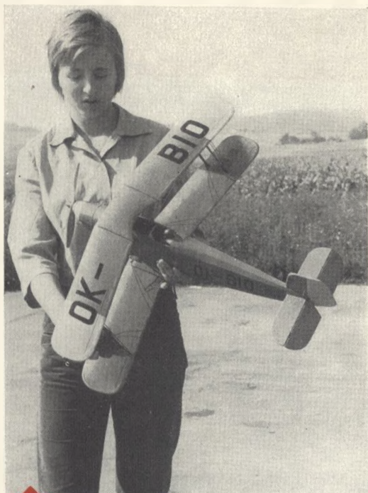
S upoutanou „C-stočtyřkou“ ve vlečné úpravě podle plánu Modelář z padesátých let létá Hana Bedřichová z Brna. Pohon je motorem MVVS 2,5 D
