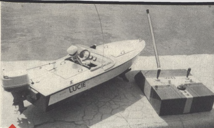
S rádiem řízeným Čolkem podle plánu Modelář si letos pěkně zajezdil Ladislav Andrašák ze Šumperka. Závěsný motor Graupner 4,5 V, RC souprava W-43, zatím dvoukanálová
