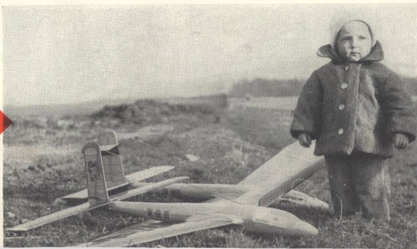
RC větroně P. Lanika a S. Horvátha z LMK Brušperk mají rozpětí 2350 a 2440 mm, váží 1250 a 2350 g a mají nosnou plochu 42 + 9 a 49 + 11 dm 2 . Zatím je řízena jen směrovka (navíjením nitě, přijímač Mars), počítá se s čtyřkanálem
