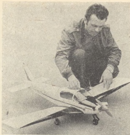
RC maketa francouzského sportovního letadla Wassmer WA 40, se kterou J. Vylíčil ze Šumperka obsadil 3. místo na letošní mezinárodní soutěži v K. Varech. Rozpětí je 1400 mm, motor OS MAX 8,3 cm 3 , radio Varioprop 10. (Laminátový trup a stavební plánek na tento a jiné modely může dodat LMK Šumperk)
