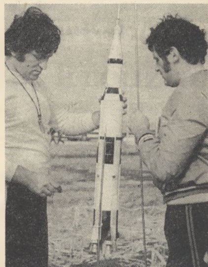
Bulhaři létali s maketami Saturn V s jediným motorem o impulsu 25 Ns, který jen stěží zajistil bezpečný stabilní let modelu
