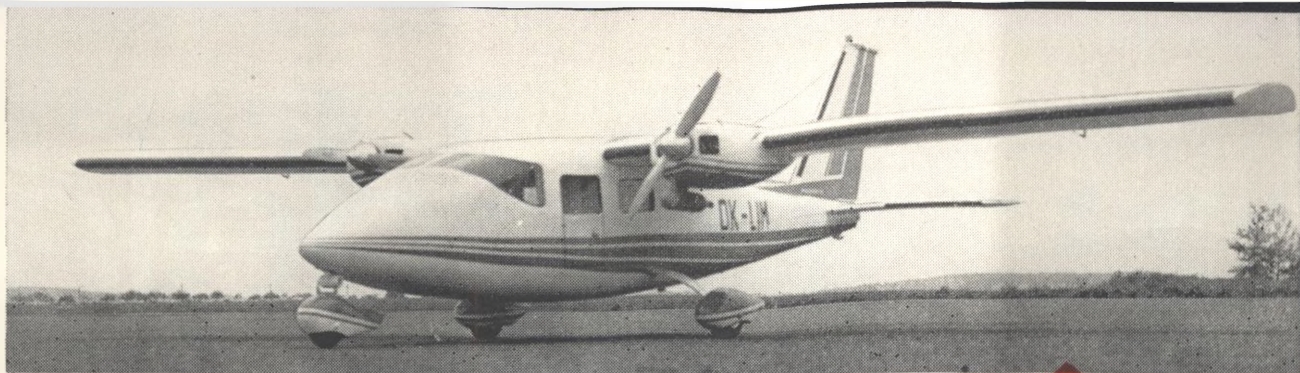
Sportovní RC maketu Partenavia Victor si navrhl a postavil R. Liehman z LMK Drozdov. Má rozpětí 2620 mm, dva motory HB 10 cm 3 , hmotnost 10 kg; použitá RC souprava je Varioprop 27 FM
