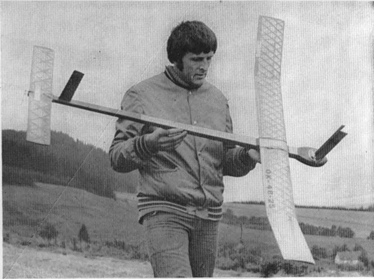
▲ Nováček v kategorii F1E, K Brandejs z LMK Borohrádek, použil s úspěchem na svůj „magneták“ křídlo a vodorovnou ocasní plochu z vyřazeného modelu Wakefield
