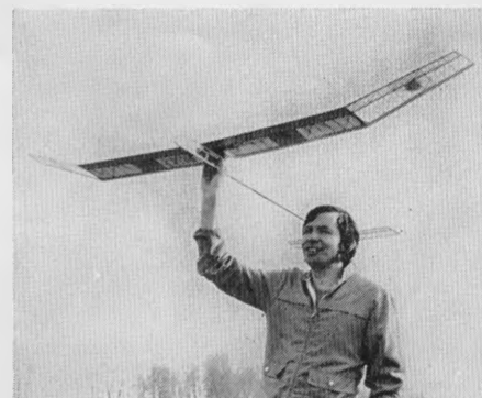
Fik – model větroně kategorie F1A pro mírně pokročilé modeláře; rozpětí 2065 mm, stavba z balsy. (Viz Modelář č. 7/1978)
