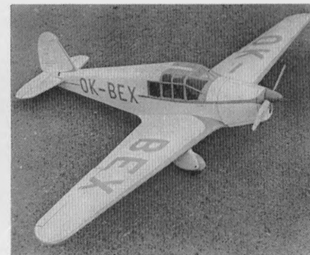
Superblibi – upoutaná maketa čs. sportovního letadla Be 555 na motor 2,5 až 3,5 cm 3 ; poměr zmenšení vůči vzoru 1 : 8,5, rozpětí 1176 mm, stavba z balsy. (Viz Modelář č. 8/1978)
