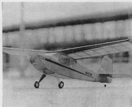
Ranquel – sportovní volný model letadla s pohonem gumovým svazkem nebo motorem Modela CO 2 (0,27 cm 3 ); rozpětí 744 mm, stavba z balsy. (Viz Modelář č. 2/1978)
