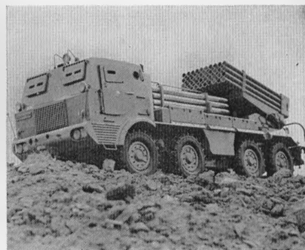
Tatra 813 8 x 8 – model československého obrněného automobilu na elektrický pohon; délka 463 mm, stavba ze smíšeného materiálu. (Viz Modelář č. 11/1977)
