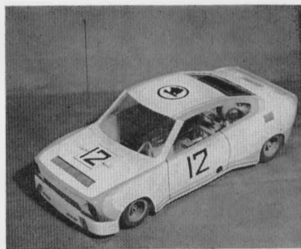
Škoda 130 RS – model automobilu kategorie RC V2 na motor Modela MVVS 2,5 GR; poměr zmenšení vůči vzoru 1 : 8, délka 520 mm, stavba z tuzemského materiálu. (Viz Modelář č. 4/1978)
