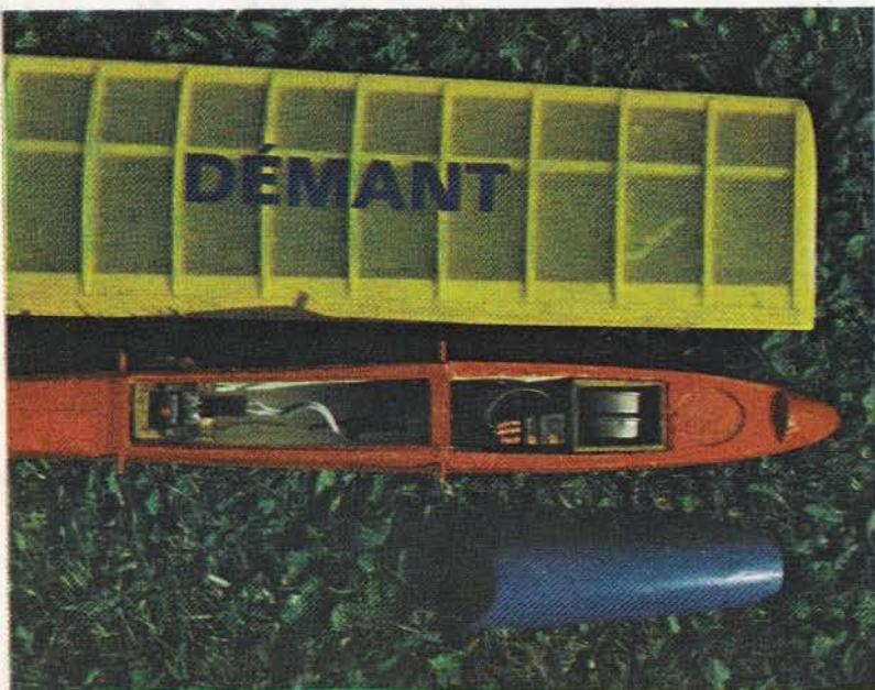
▲ Model DÉMANT 800 ze stavnice Modela upravil na RC větroň ing. Metoděj Šváříček z Bystřice nad Pernštejnem. Směrovka je ovládána otočným feritovým magnetem připojeným k upravenému přijímači Brand Hobby, napájenému ze dvou článků NiCd 225. Hmotnost modelu je 150 g
