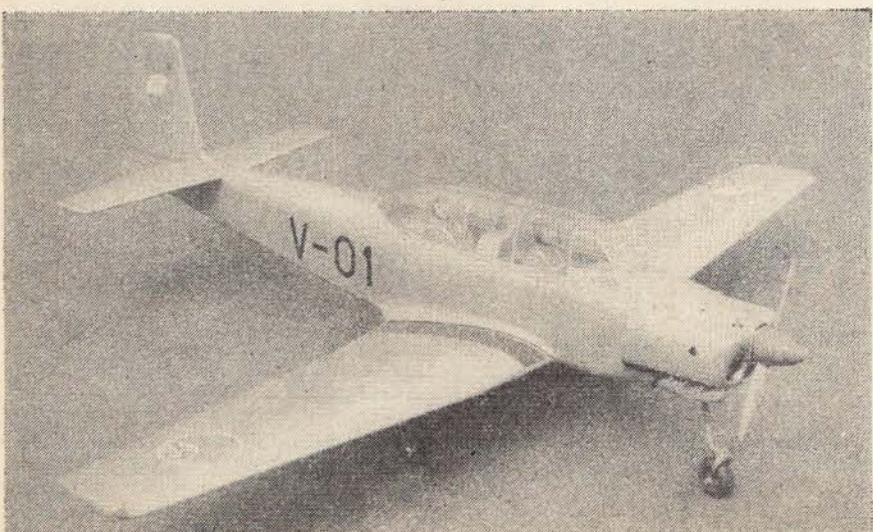
**Povrchová úprava** nemá zvláštnost. Celý model je po vybroušení nastříkan stříbrným emalem, napodobujícím povrch hliníku.
