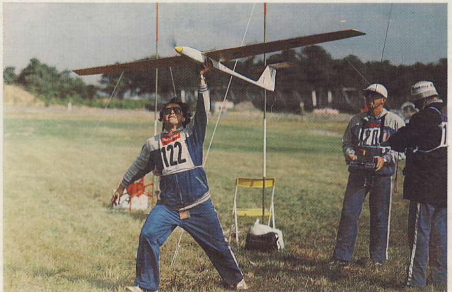
▼ První mistr světa v elektroletu Rudolf Freudenthaler z Rakouska létal s motorem Keller 200, napájeným ze dvou sad 30 akumulátorů o kapacitě 0,7 Ah
