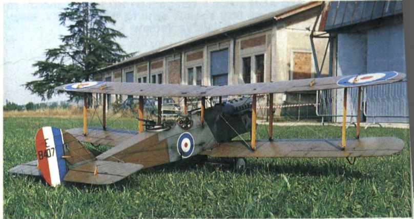
▲ Po statickém hodnocení první, celkově pak druhý skončil na X. MS RC maket v Itálii model Aircro DH-9A P. McDermotta z Velké Británie. Maketa v měřítku 1:6 je při letové hmotnosti 6200 g poháněna čtyřdobým motorem Lase 25 cm 3
