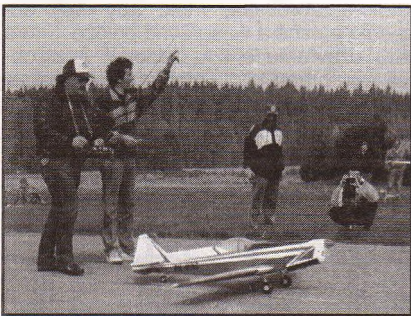
▼ Zlín 526 AS V. Kabáta z Českých Budějovic. Rozpětí 2 150 mm, hmotnost 7 kg, motor Super Tiger 30 cm 3 .
