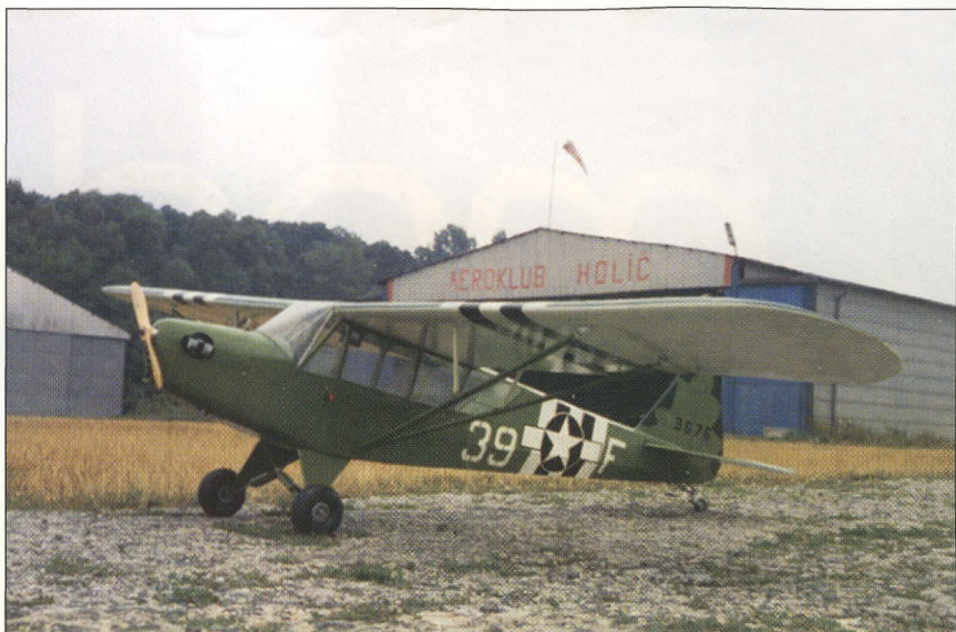
Polomaketa letounu Piper L-4H Grasshopper Olina Vításka z Holíče má rozpětí 2500 mm a hmotnost 4800 g; poháněna je motorem OS Max 10 cm 3 , RC soupravou Robbe Rex jsou ovládnuty motor, kormidla a křídélka
