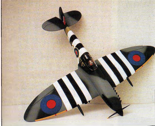
▲ Spitfire Mk-IX Supermarine - polomaketa známého stíhacího letounu v měřítku 1 : 8. Polomaketa od plzeňské firmy Savex je v dokončeném stavu pro instalaci motoru ( 6,5 až 7,5, výjimečně i 10 cm 3 ) a RC vybavení. Pro křídlo je použit profil MH-24, konstrukčním materiálem je laminát a uhlíková vlákna. Rozpětí 1440 mm, délka 1200 mm, letová hmotnost 2400 až 2900 g.
