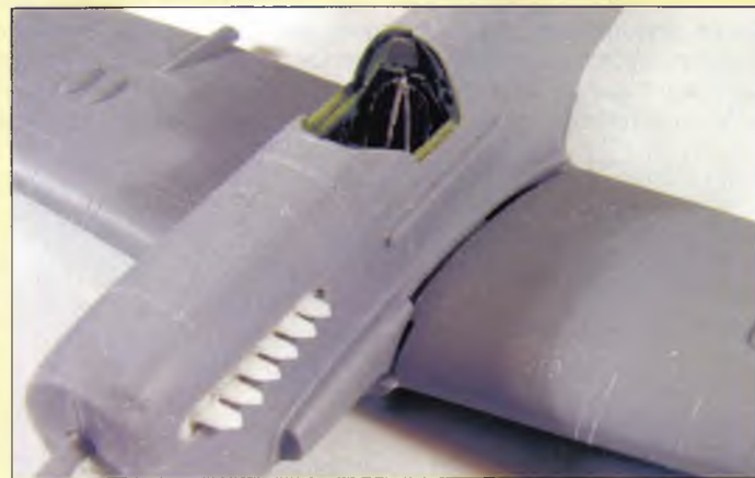
Tato partie byla patrně nejnáročnější fází stavby, protože křídlo s trupem vůbec nelícovalo - na jedné straně vznikla dvoumilimetrová mezera, zatímco na straně druhé přibližně stejné množství materiálu přebývalo. K dokonalosti měl daleko i spoj na spodní straně
