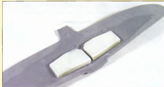
Pro bezproblémovou instalaci odlítka podvozkové šachty do křídla a její překrytí horními částmi je nutné jak šachtu, tak vnitřní část spodního dílu křídla značně obrousit. Stejná procedura potkala i odtokovou část
