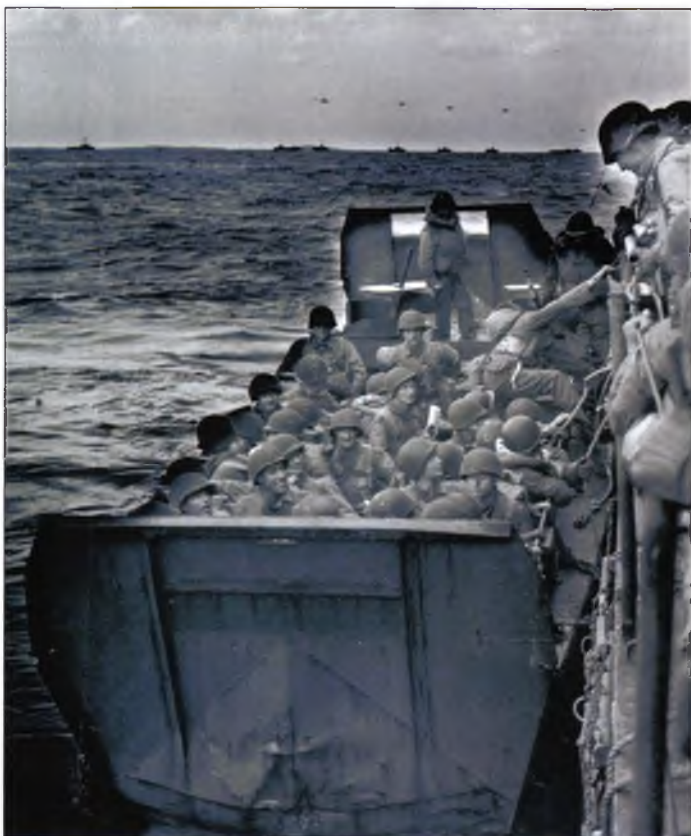
Nalodování útočných jednotek z mateřských lodí bylo i na klidném moři komplikovanou záležitostí. Všimněte si značného opotřebování sklupné rampy; z nýtů, svárů a odřených míst rez přímo teče
