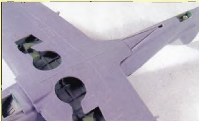
Výřez ve spodní části trupu pro díl znázorňující uložení přistávacího háku bylo potřeba mírně zvětšit, součástku doporučuji ještě před zaschnutím lepidla slícovat s křídlem, jinak nás opět čeká broušení a tmelení ▼
