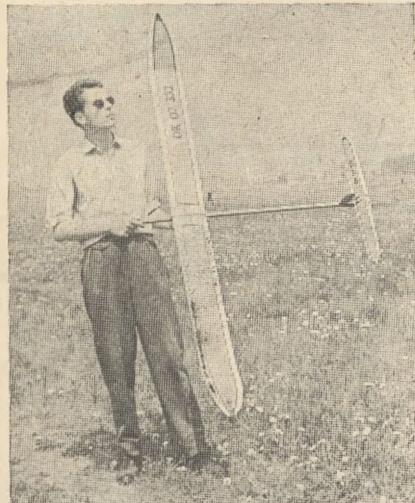
užívám výhradně Epoxy 1200. Hlavici trupu tvoří kužel vysoustružený z mosazi a těsně suvný do trupové trubky; za ním je možno umístit schránku na jemné dozáření. **Směrovka** je z plné balsy tl. 2 mm, „ploutev“ z balsy 3 mm.
