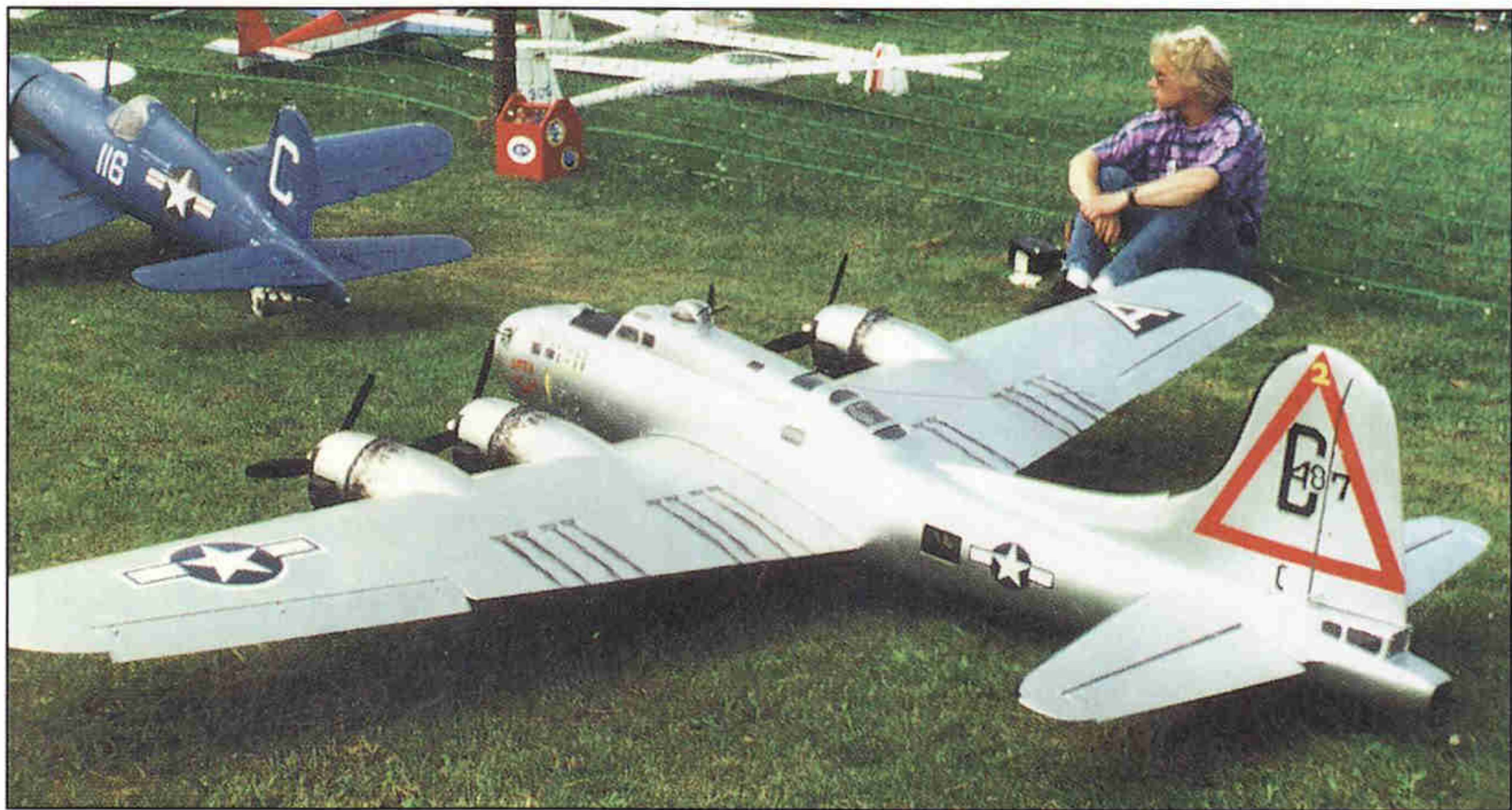
Atraktivní B-17 Dirka Bayera je poháněna čtyřmi motory Webra 15 cm 3 a váží 19,5 kg
