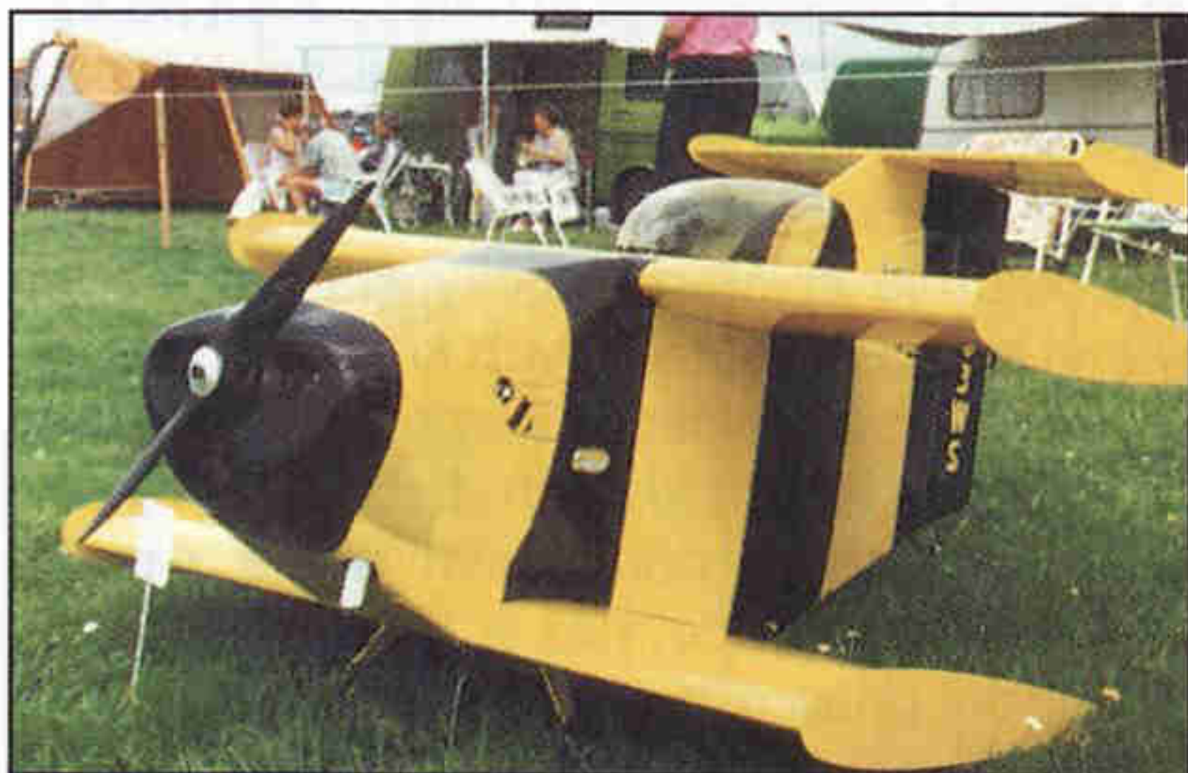
Bumble Bee Martina Bocka má rozpětí 2000 mm, hmotnost 13,5 kg a je poháněna motorem Titan 62 SL
