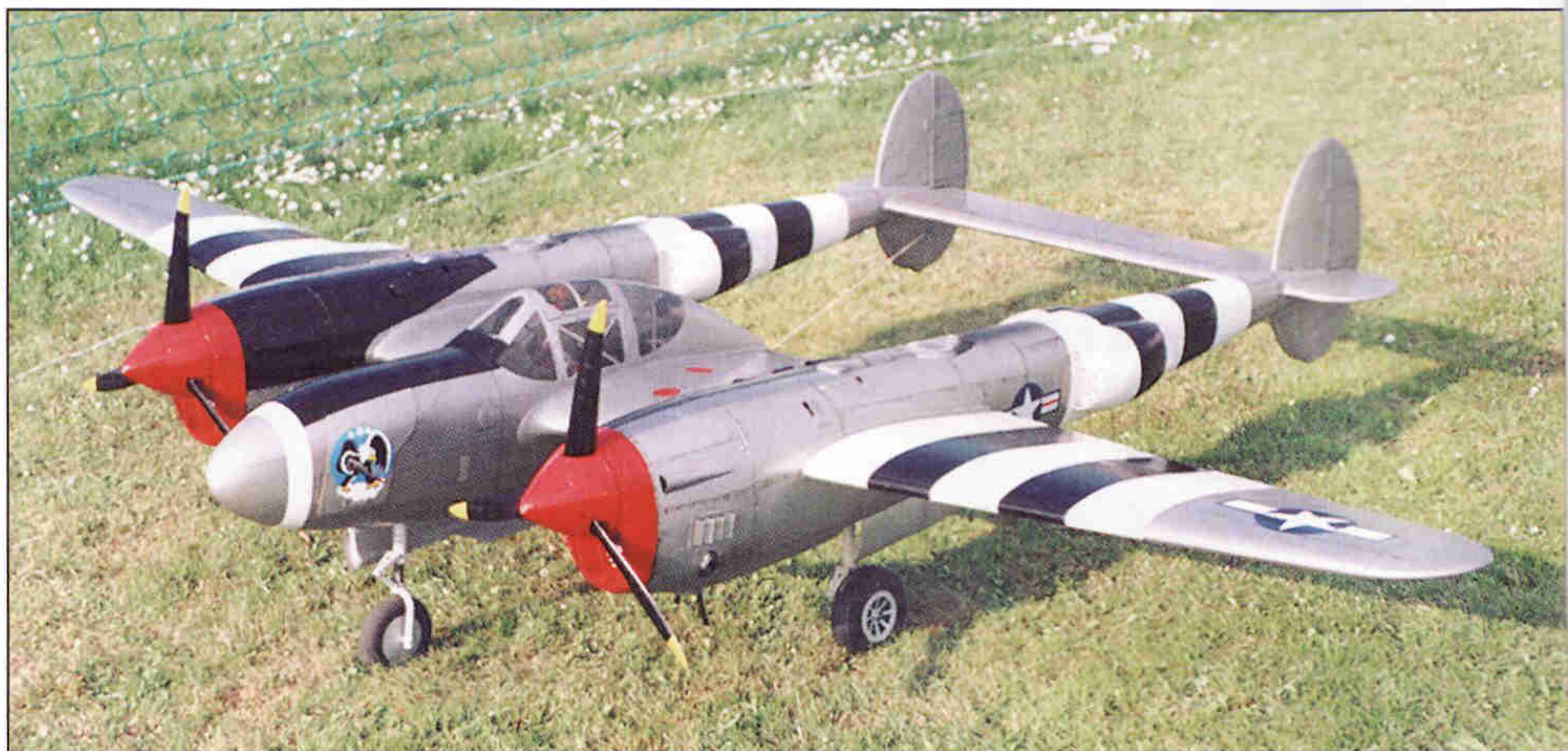
▲ Odměněný Lockheed P-38 Lightning Andrease Dehna je opatřen dvěma motory Ti- tan 38 cm 3
