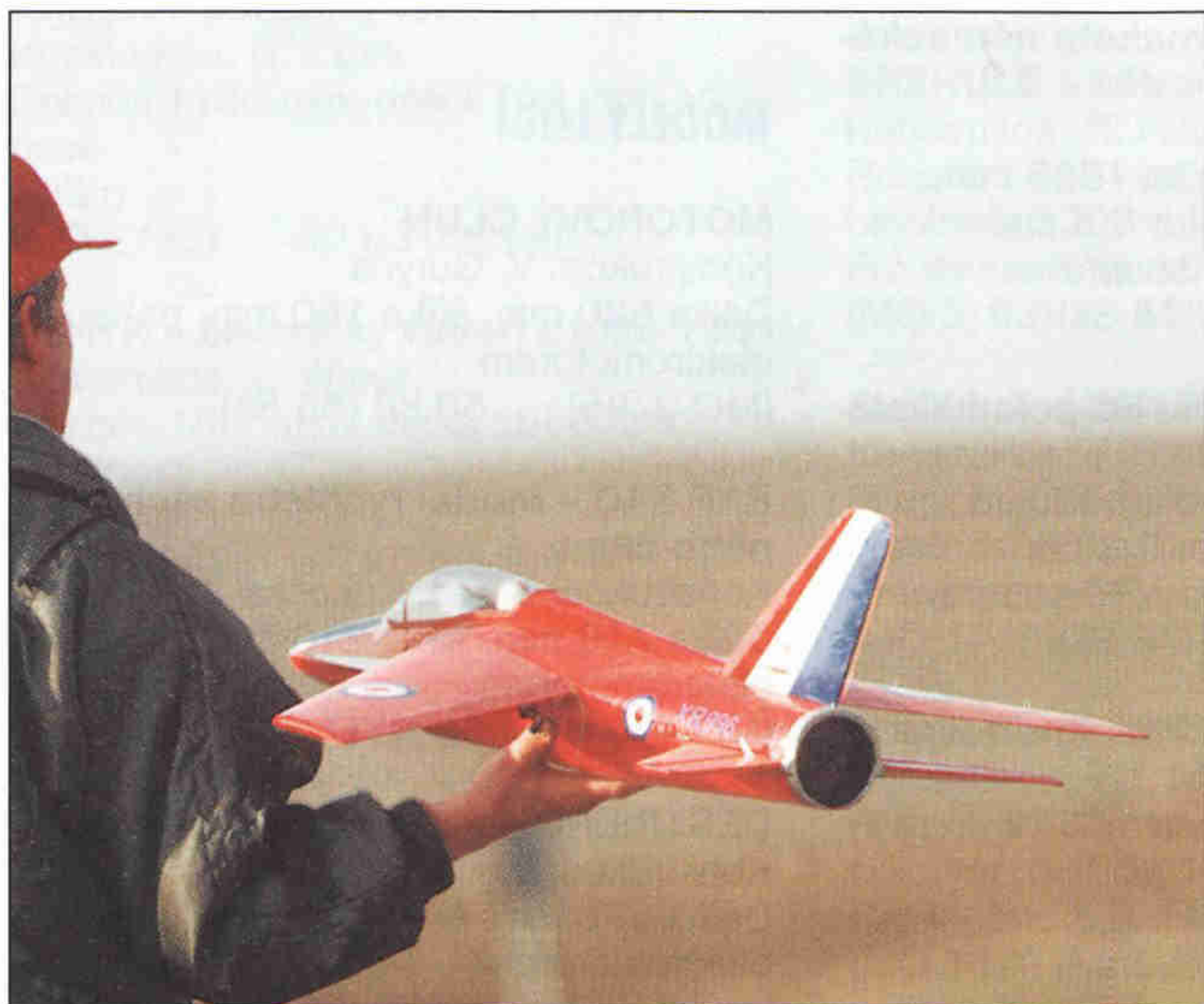
FO-141 Gnat, model firmy Robbe, je celý z po- lystyrenu. Roz- pětí 780 mm, hmotnost 900 g, pohon elektrodmy- chadlem Rojet
