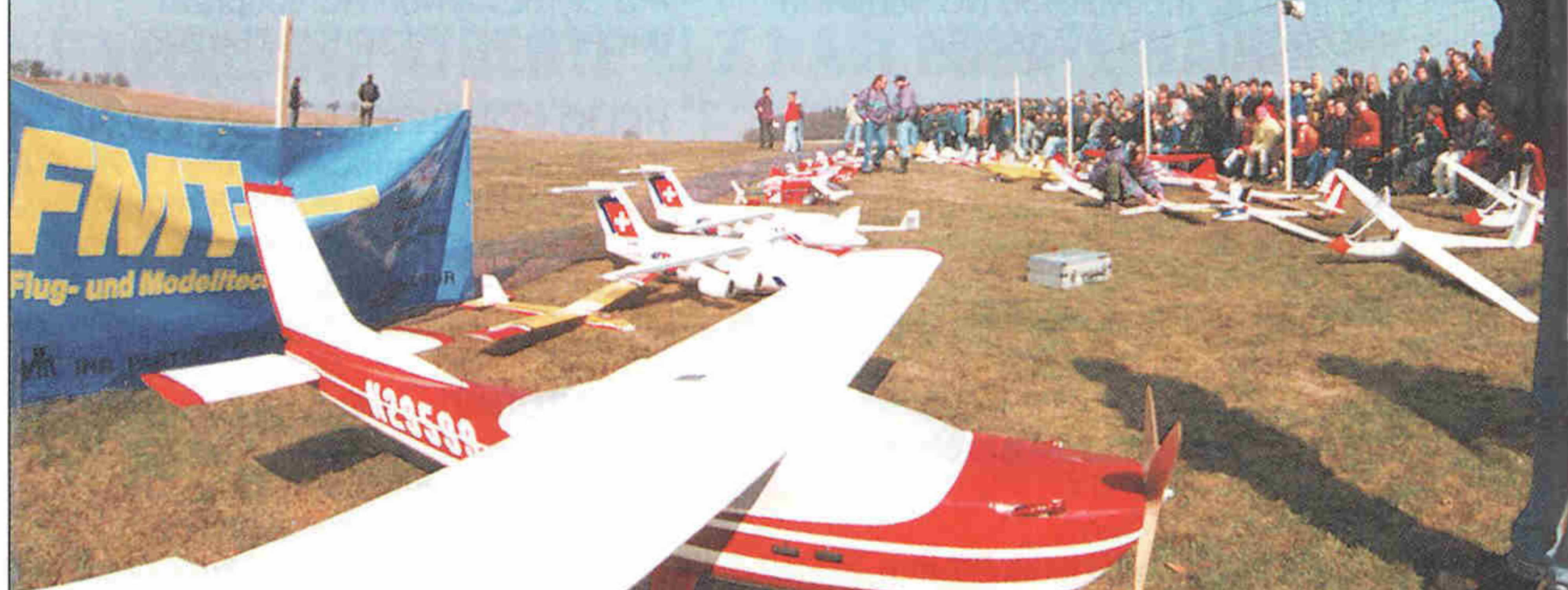
FO-141 Gnat, model firmy Robbe, je celý z po- lystyrenu. Roz- pětí 780 mm, hmotnost 900 g, pohon elektrodmy- chadlem Rojet
