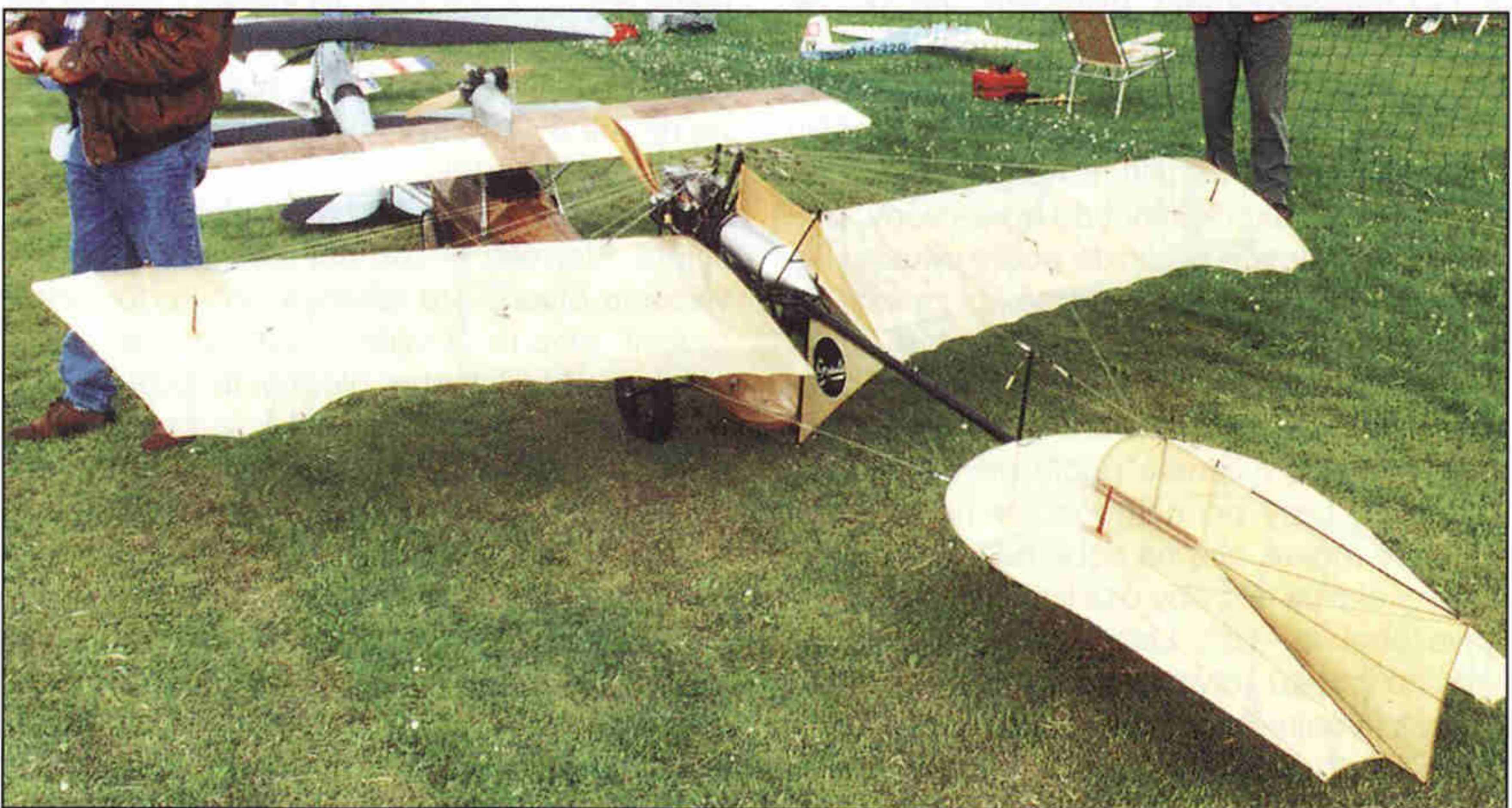
Bumble Bee Martina Bocka má rozpětí 2000 mm, hmotnost 13,5 kg a je poháněna motorem Titan 62 SL
