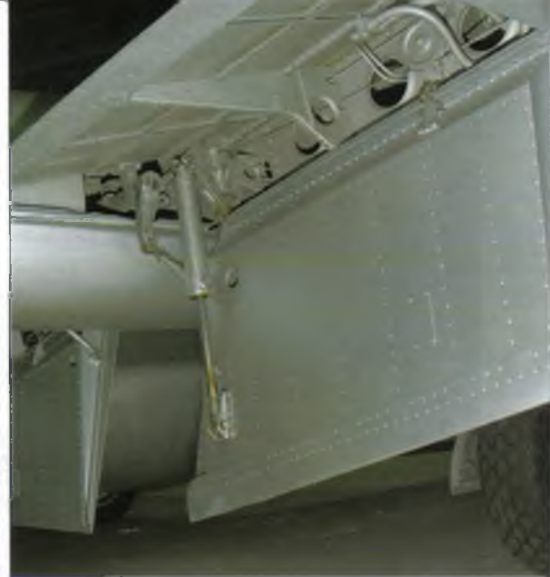
▲ „Muzeální stříbrenka“ nemusí být jen pokusem oklamat zrak návštěvníků. Stíhací letadla De Havilland Vampire měla trupovou gondolu ze dřeva a celé stroje byly, podobně jako dřívě plátnem potažené dvouplošníky, nastříkány ochrannou stříbrnou barvou. Skutečně kovovou pístnici okamžitě poznáme podle lesku
