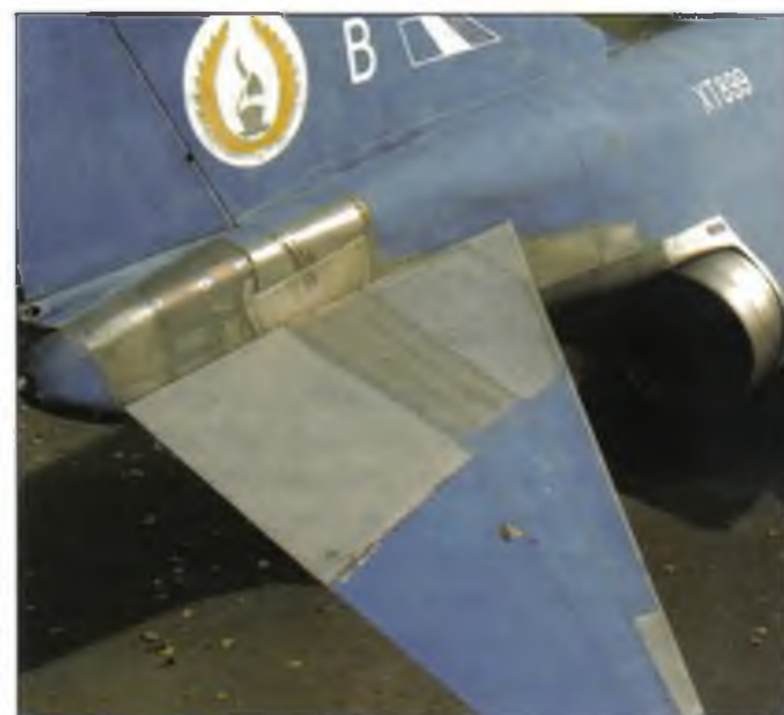
▲ Další inspirace z muzea ve Kbelích. Díly britského Phantomu, které musely odolávat žáru, byly z jiného materiálu a tudíž i jiné barvy
