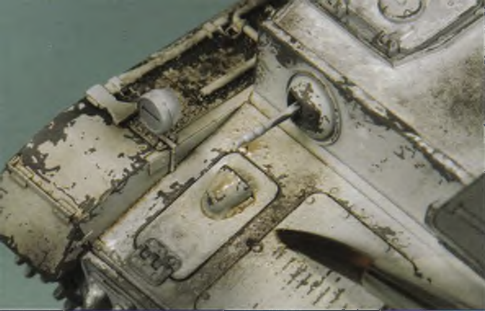
Patinu zahájíme nanesením filtrů tvořených směsí tmavě hnědých olejových a syntetických barev. Filtry se skládají z pěti dílů barvy a pětadevadesáti dílů ředidla na filtry
