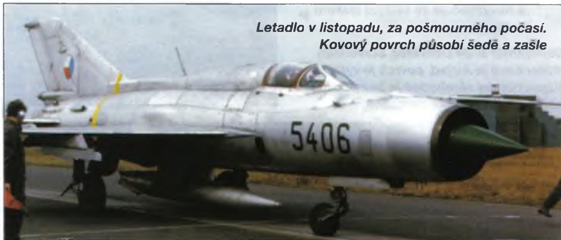
Letadlo po generální opravě. Koncem 80. let sjednocovali v leteckých opravárnách povrch jednoduším nástřikem hliníkové polyuretanové barvy. Veškeré rozdíly ve zbarvení panelů zmizely
