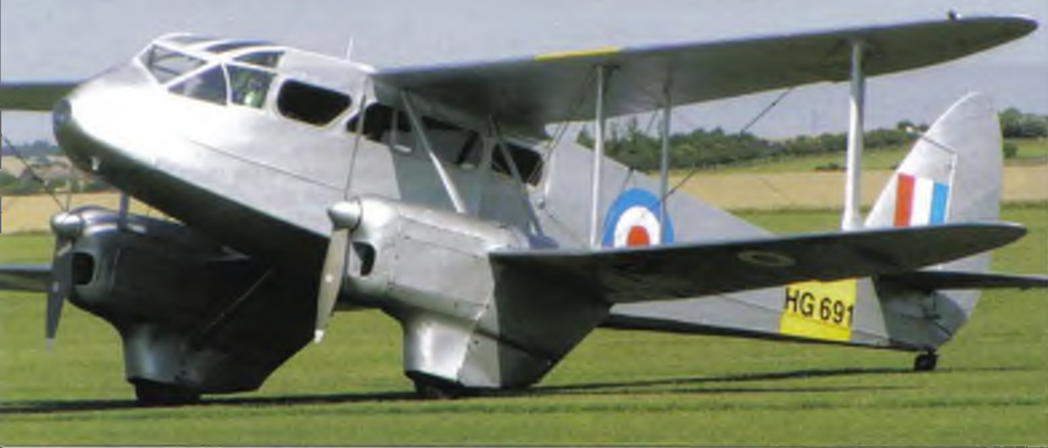
De Havilland Dragon Rapid má plátnem potažené části i plechy kolem motorů natřené stejnou barvou a díky tomu má stříbrná jednolitý mdlý odstín
