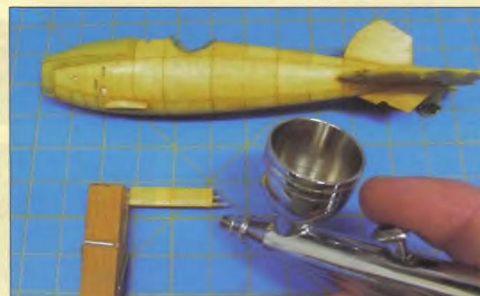
Po důkladném proschnutí (týden) přelakujeme trup druhou vrstvou polomatného akrylového laku
