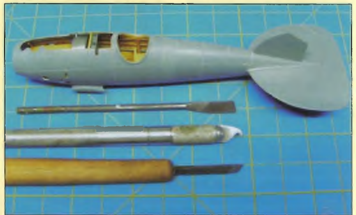
Zatmelíme přechod trupu do kořene spodního křídla. Zvýrazníme rytí a přebrousíme trup brusným papírem zrnitosti 1600 a 2000
