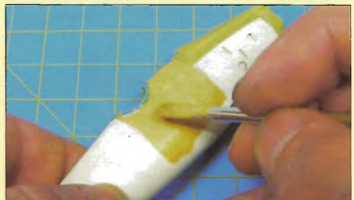
Barvu nanese na trup plochým štětcem postupně, nanejvýš v rozsahu několika panelů. Na dalších panelech pokračujeme po dokončeném tupování
