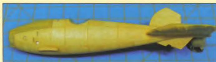
Trup s dokončenou první vrstvou necháme důkladně (nejméně týden) vyschnout
