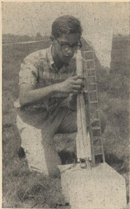
„Neviditelné“ stabilizátory měl na mistrovství USA 1966 soutěžící Jay Apt na své maketu Thor Delta. Stabilizátory (čtyři) z průhledné plastické hmoty jsou sotva patrné i na originální snímku, takže takový model působí bezpochyby velmi realisticky
