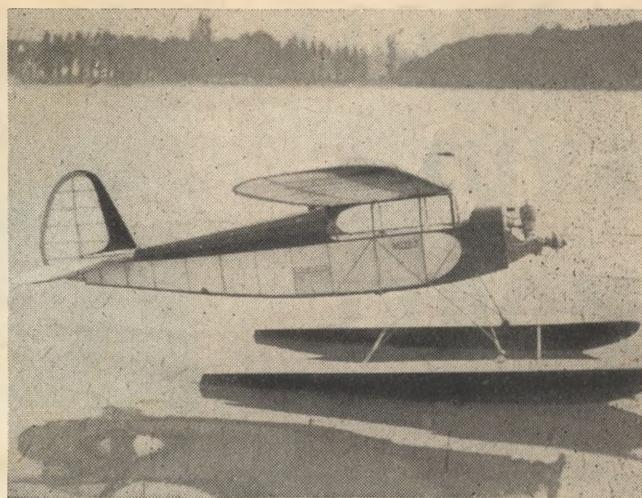
Dnes už téměř čtvrt století starý snímek sportovního neřízeného modelu, který byl dodatečně vybaven plováky a spolehlivě vzlétal z vody. Rozpětí modelu bylo 1600–1750 mm (několik křidel) pohon motorem Ipro – Ikar 6,3 cm³ s jiskřivou svíčkou, konstrukce J. Smoly
