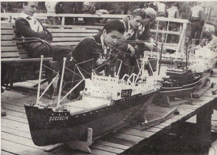
▲ Maketa obchodní lodě „Szczecin“ je prací T. Moloczika z Lublinu. Má „požehnanou“ délku 2 m, výtlač 80 kg a pohon stíračovým elektromotorem 12 V
