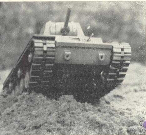
Maketu sovětského tanku KV postavil P. Hoštálek z Liberce. Model je poháněn dvěma motory IGLA DMP-3, věž je ovládána motorem IGLA E-1. Řízení je kablem z rozváděcí skřínky
