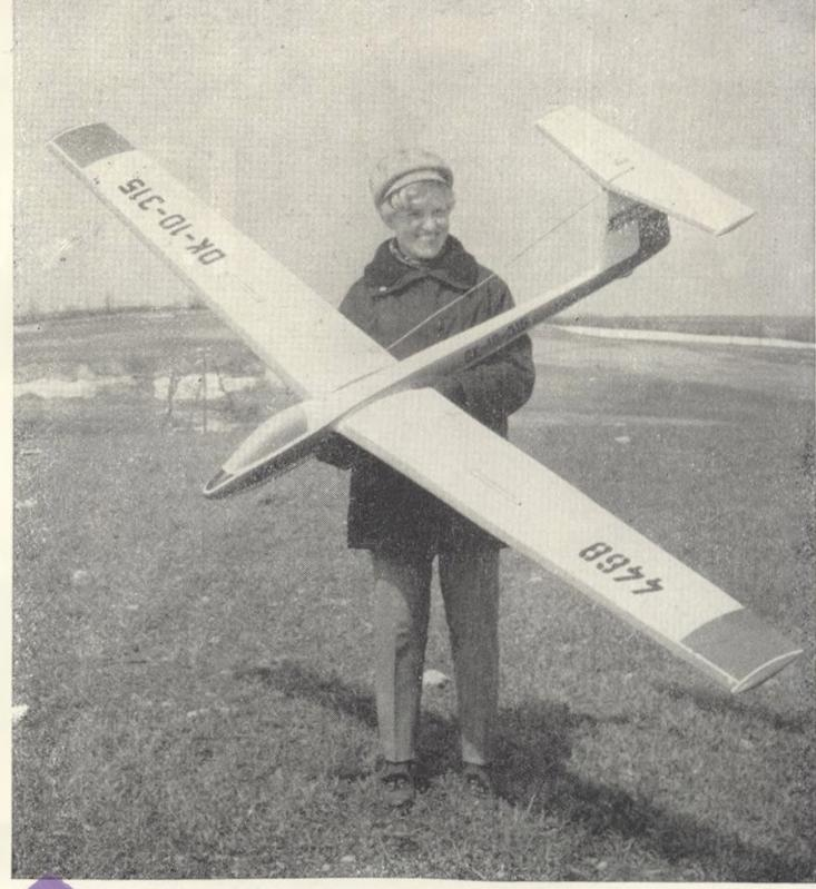
Nový větroň ing. J. Heyera má rozpětí 2,90 m a váží 3 kg. Deseti-kanálová RC souprava ovládá výškovku (nedělenou), směrovku, trim, křídélka a brzdící klapky spřažené s výklopným podvoz-tem
