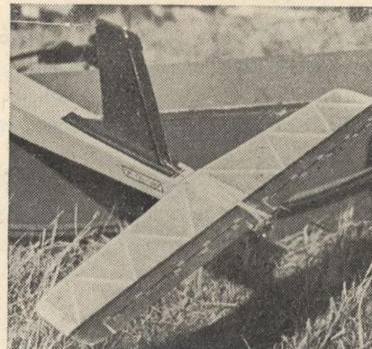
Detail riadiacich plôch modelu „RC-3“. Vysvetlenie: 1. tiahlo, 2. spätná pružina, 3 spojovací drôt pohyblivej časti výškovky
