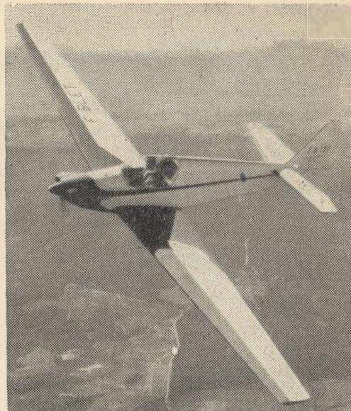
wagen Rectimo 4 AR 1200 o 39 k poháněj pevnou dřevěnou vrtuli. Motor upravuje firma Rectimo zamontováním speciálního karburátoru, zapalovacích magnet z motoru Continental 65 k a řadou dalších změn včetně odlehčení. Palivo o celkovém množství 60 l je ve dvou nádržích.
