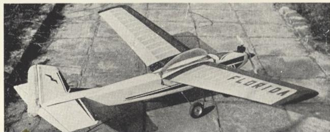
Floride (pozměněná) V. Mušky z Kys. N. Mesta. S motorem Jena 2,5 a jednokanálovým rádiem váží 2050 g
