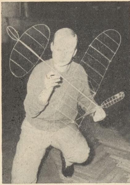
*Rekordní model J. Kaliny, potažený velmi suchým mikrofilmem. Model má větší nosnou plochu než model na gumu typu Wakefield – celkem 21,3 dm<sup>2</sup> a jeho třetí varianta je držitelem nejvyššího výkonu u nás: 23 min. 9 sec*
