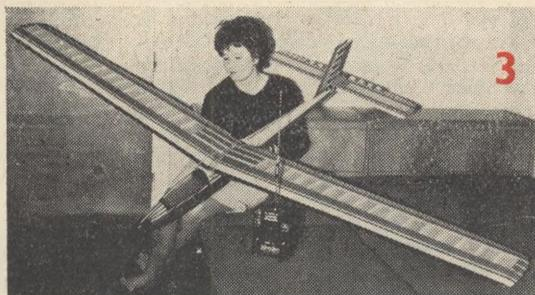
nepříliš vhodných podmínek (obr. 1) a protože pokus dopadl v zásadě klidně, postavil jsem přes zimu větroň Niké (obr. 2). Má rozpětí 2700 mm, nosnou plochu 61 + 10 dm<sup>2</sup> profil křídla NACA 64a410 a váží bez radia 1800 g. RC souprava Citizen Ship SL-6 ovládá obě kormidla.
