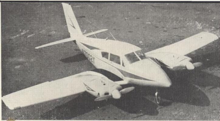
U-maketu Piper Twin Comanche na motory Jena 2,5 postavil 17letý S. Křivák, člen LMK Unicov. Rozpětí 1560 mm, váha 2400 g, zatahovací podvozek, plovoucí výškovka
