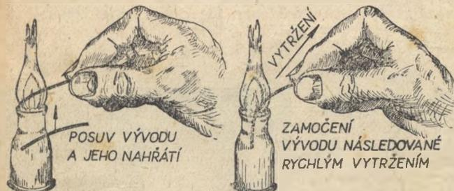
Obr. 8. Opalování vývodů z jemných drátů nebo lanek
