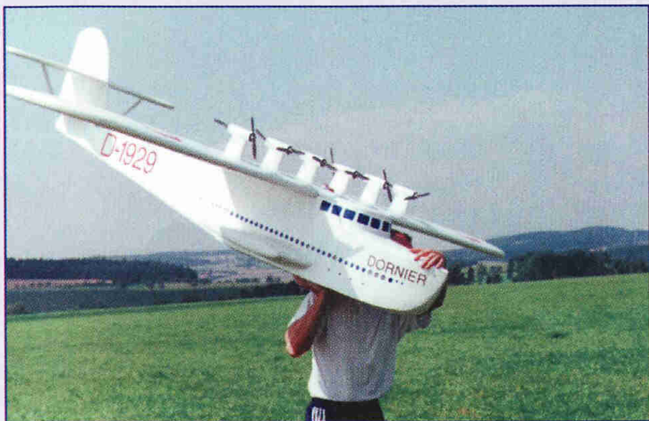
Velkolepý létající člun Dornier Do-X. Maketa v měřítku 1:20 je poháněna dvanácti elektromotory SPEED 400, které pohánějí šest tažných a šest tlačných vrtulí. Rozpětí 2400 mm, délka 2000 mm, letová hmotnost 6300 g. Maketu postavil Juraj Tinka.
