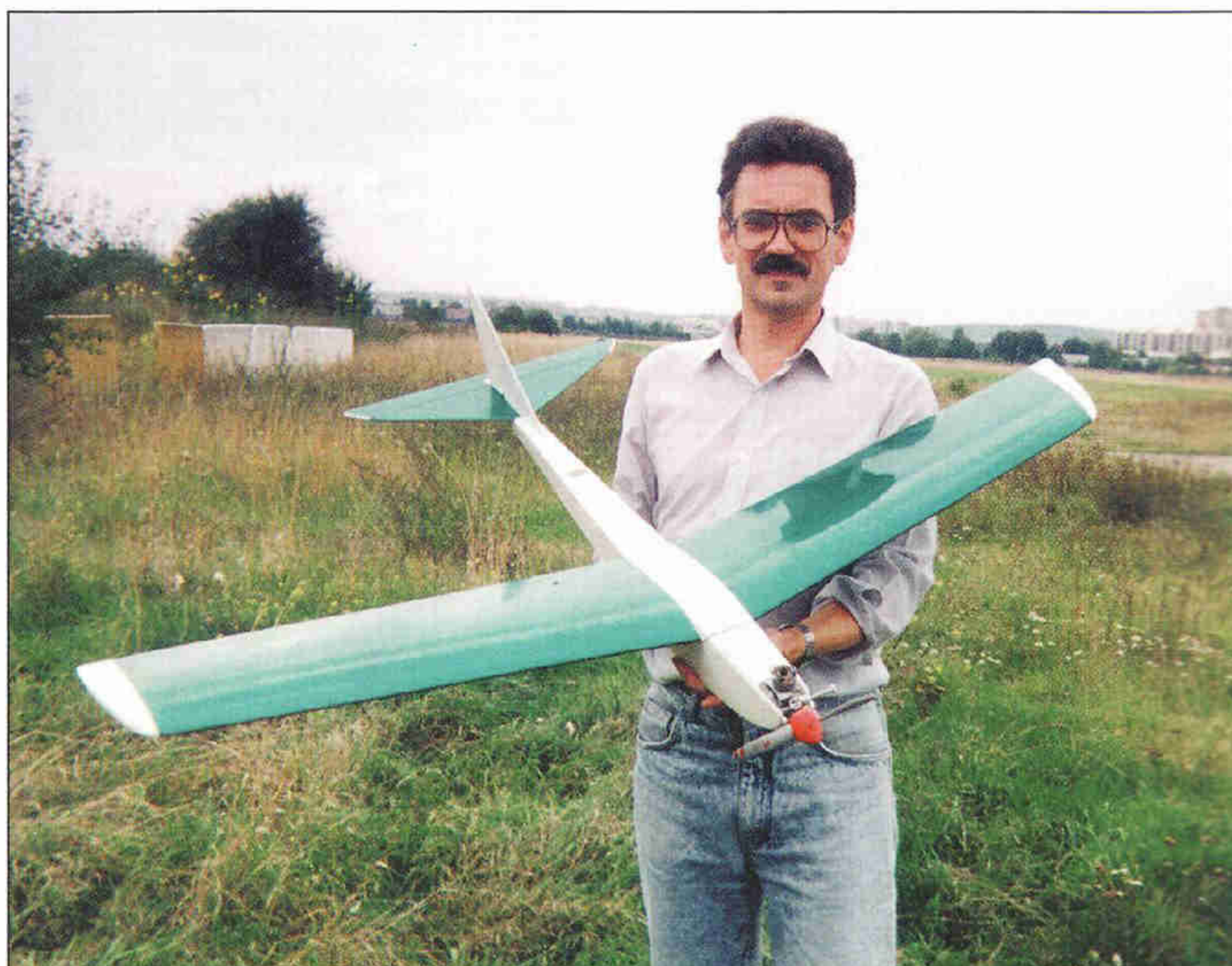
Ing. E. Příbyl s motorovým RC modelem vlastní konstrukce, který dokončil v loňském roce. Celobalsový model má rozpětí 1 380 mm, hmotnost 1 200 g, pohon „žhavíkem“ ENYA 1,6 cm 3 . Dvoukanálovou soupravou je ovládána směrovka a výškovka.
