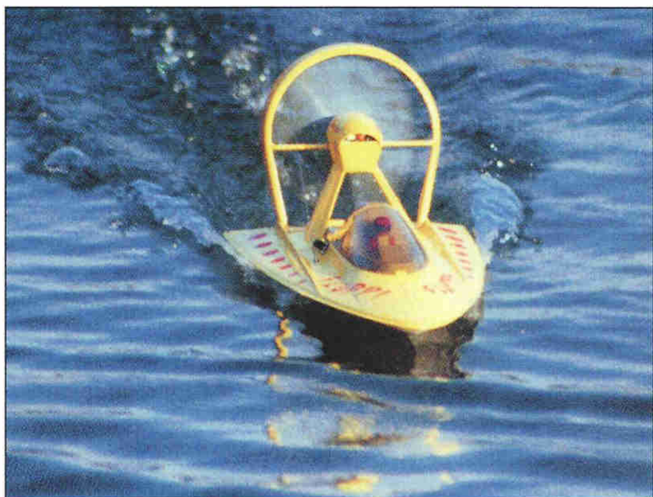
Model rychlostního člunu FLUPPI (délka 485 mm, šířka 222 mm) od firmy Graupner. Pohyb člunu zajišťuje tlačná vrtule poháněná elektromotorem SPEED 600 (7, 2 V). Kompletně vybavený model o hmotnosti téměř 1 100 g dosahuje maximální rychlost 20 km/h. Funkce lodi jsou ovládány RC soupravou.
