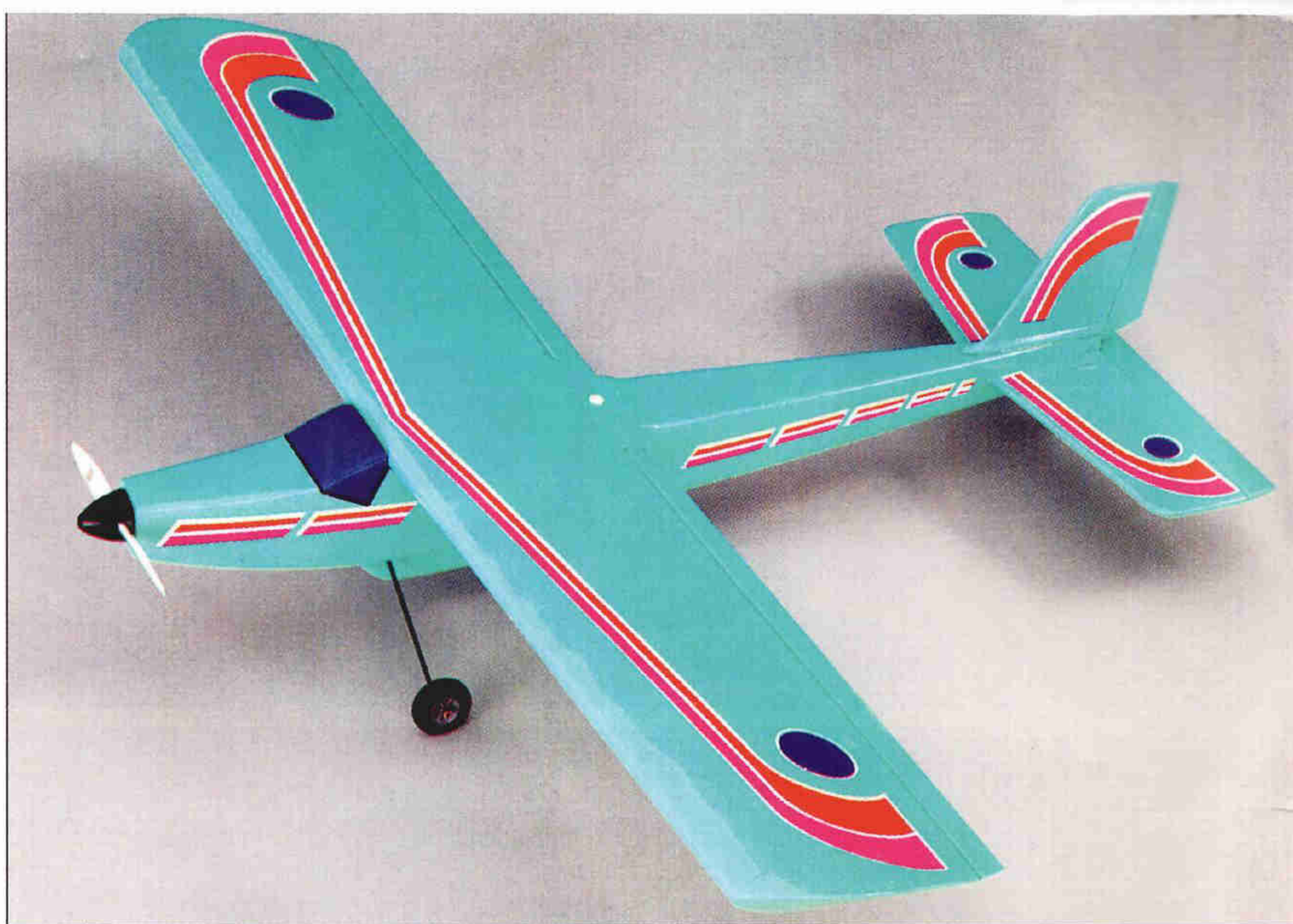
Úhledný hornoplošník firmy Jamara. Jde o RC elektrolet, rozpětí 1 390 mm, délka trupu 970 mm, hmotnost bez RC vybavení 1 700 g.
