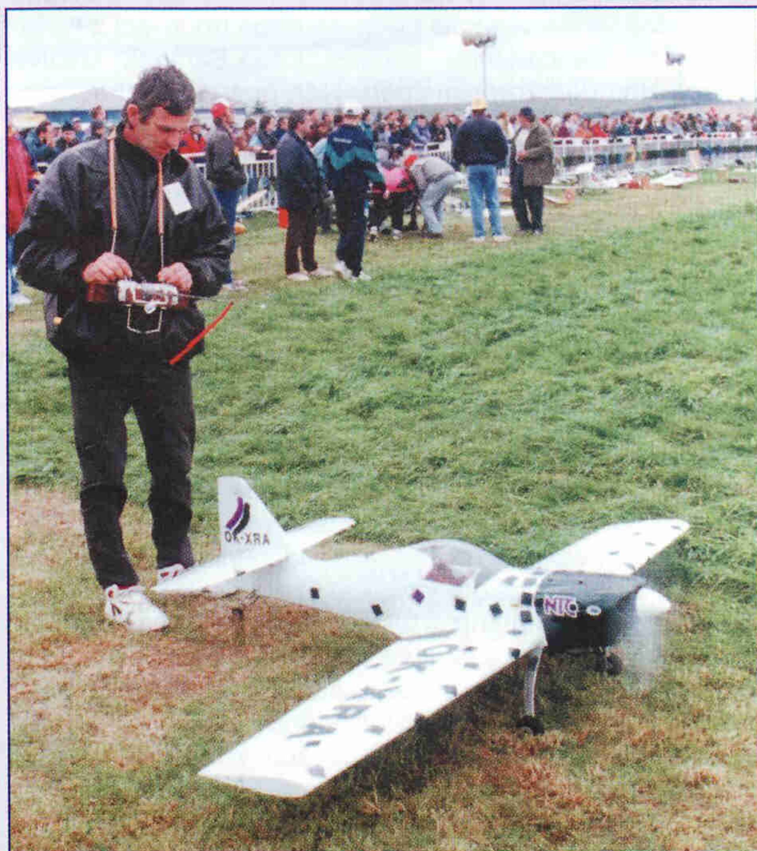
Novinka letošního jara. Maketu Aero Z-50 postavil František Havlíček z Boskovic. „Zet padesátka“ klasické konstrukce má rozpětí 2200 mm (dýhová křídla jsou polepena balsou), hmotnost 8500 g, k pohonu slouží motor ZDZ, vrtule 500/200 mm je vlastnoručně vyrobena pilotem.
