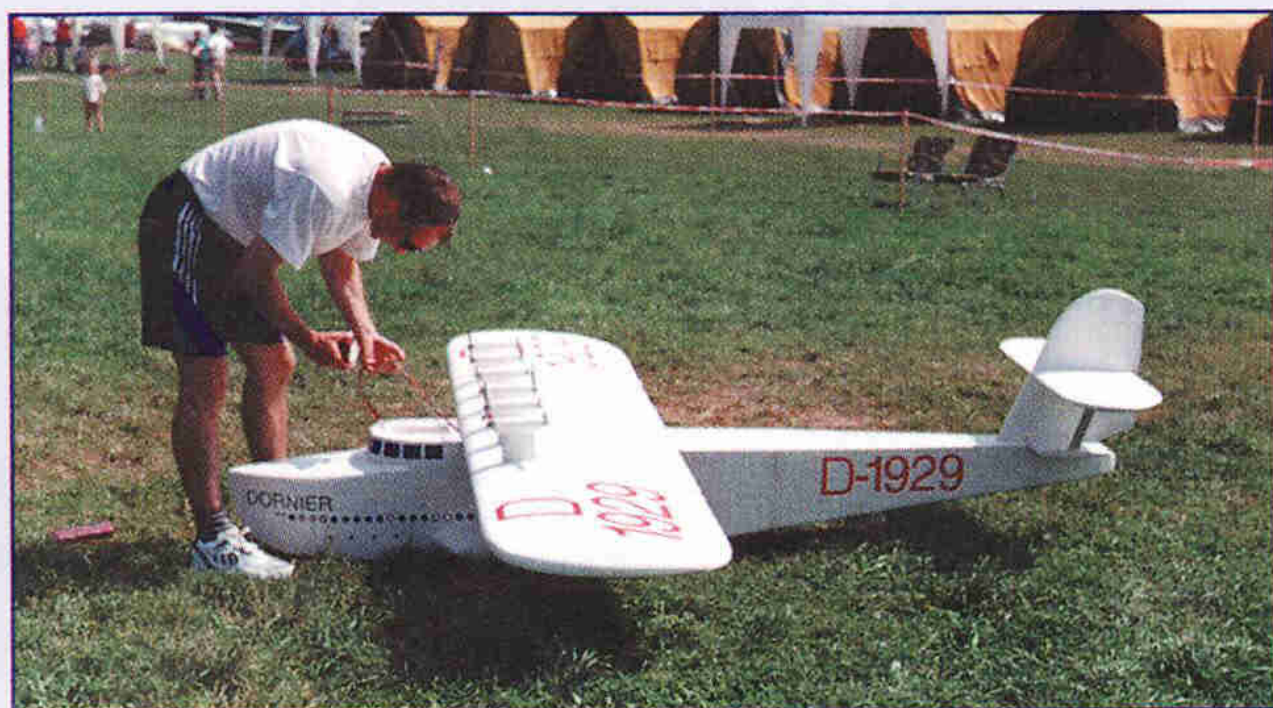
Velkolepý létající člun Dornier Do-X. Maketa v měřítku 1:20 je poháněna dvanácti elektromotory SPEED 400, které pohánějí šest tažných a šest tlačných vrtulí. Rozpětí 2400 mm, délka 2000 mm, letová hmotnost 6300 g. Maketu postavil Juraj Tinka.
