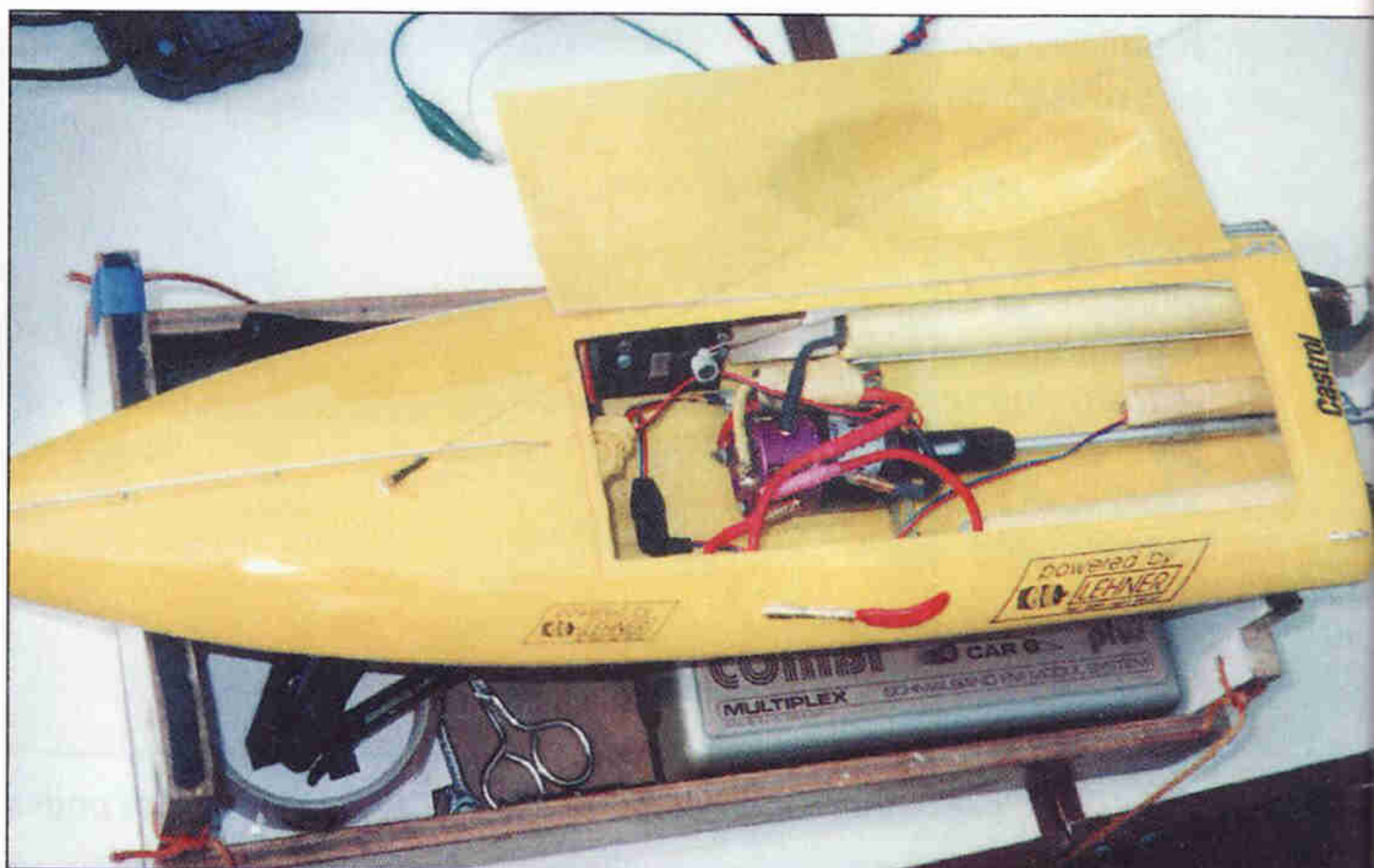
Model třídy Mono 1 mistra světa H. Lehnera z Německa. Na levém boku je dobře vidět předepsaný bezpečnostní vypínač pohonných zdrojů.
