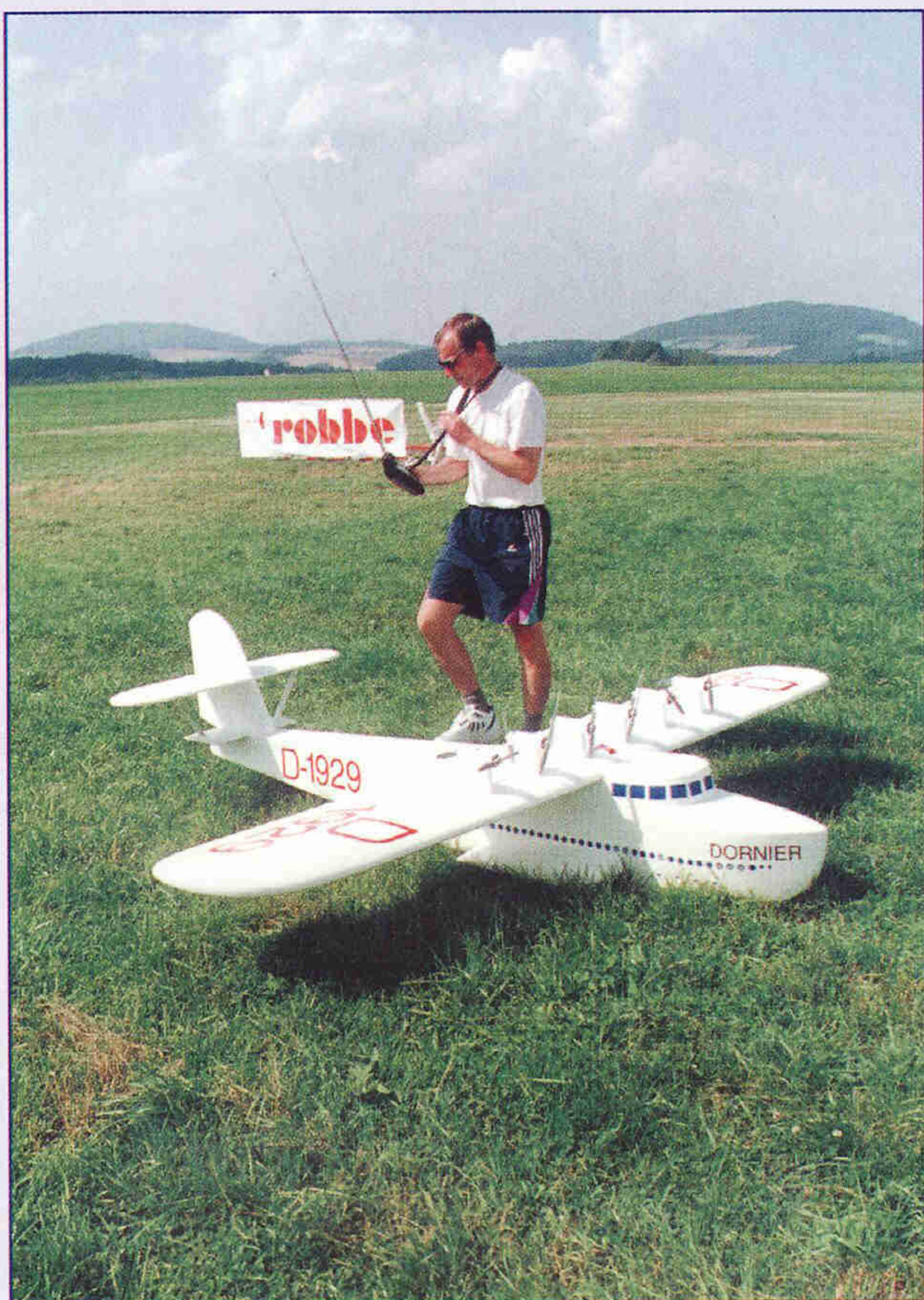
Velkolepý létající člun Dornier Do-X. Maketa v měřítku 1:20 je poháněna dvanácti elektromotory SPEED 400, které pohánějí šest tažných a šest tlačných vrtulí. Rozpětí 2400 mm, délka 2000 mm, letová hmotnost 6300 g. Maketu postavil Juraj Tinka.
