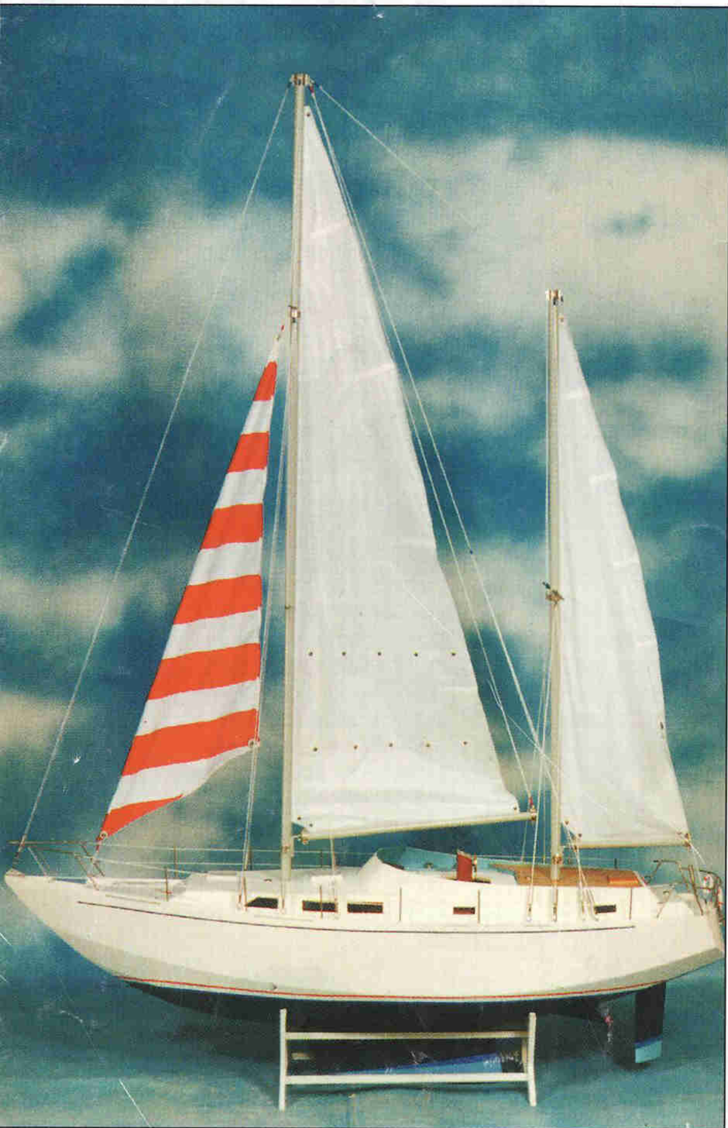
Model polské plachetnice BRUCEO postavil Jaroslav Jankovič ze slovenské Senice. Model je dlouhý 1360 mm, výška hlavního stěžně 1500 mm, hmotnost olověného závaží v kýlu 6 kg. Stavba je provedena klasicky, 3x lomená šarpie, potah z letecké překližky tl. 1 mm. RC soupravou (Futaba) jsou ovládány všechny plachty, kormidlo i pomocný elektromotor SPEED 400.
