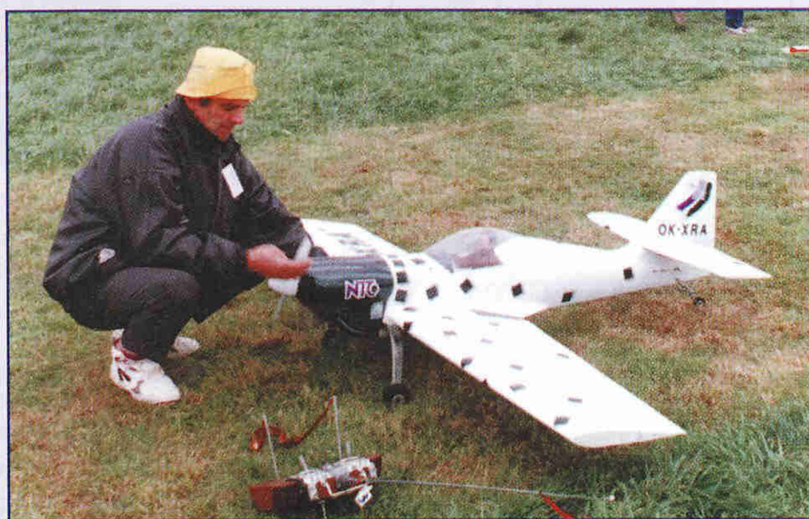
Novinka letošního jara. Maketu Aero Z-50 postavil František Havlíček z Boskovic. „Zet padesátka“ klasické konstrukce má rozpětí 2200 mm (dýhová křídla jsou polepena balsou), hmotnost 8500 g, k pohonu slouží motor ZDZ, vrtule 500/200 mm je vlastnoručně vyrobena pilotem.
