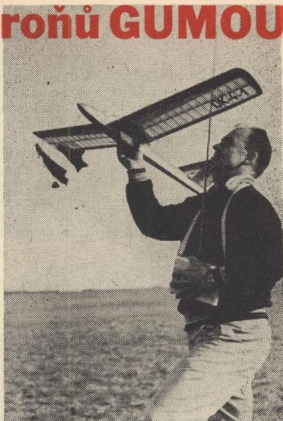
Především vlek pomocí gumy řeší jeden z hlavních problémů: jak odstartovat s RC větroňem sám bez pomocníka. Jaké vybavy je zapotřebí? Přijde na druh větroňe. Sam jsem odkoušel 3 dosti odlišné modely: „Delfín“ o rozpětí 2 m a váze 1 600 g, „Minx“ o rozpětí 1 300 mm a váze 645 g (oba modely viz MO 10 a 11/66) a dále nový RC větroň velikosti A-2. Mohu tedy říci, že popsaným zařízením lze bezpečně odstartovat modely o váze 500—1 600 g a o velikosti asi do 2,5 m rozpětí.
