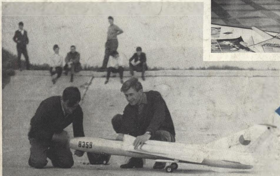
Zalétávání polomakety MIG-21, postavené M. Dobrovólným z LMK Piešťany. Model o délce 1900 mm, rozpětí 998 mm a váze 4000 g létá s motorem MVVS 5,6 cm<sup>3</sup>, potřeboval by však výkonnější „desítku“
