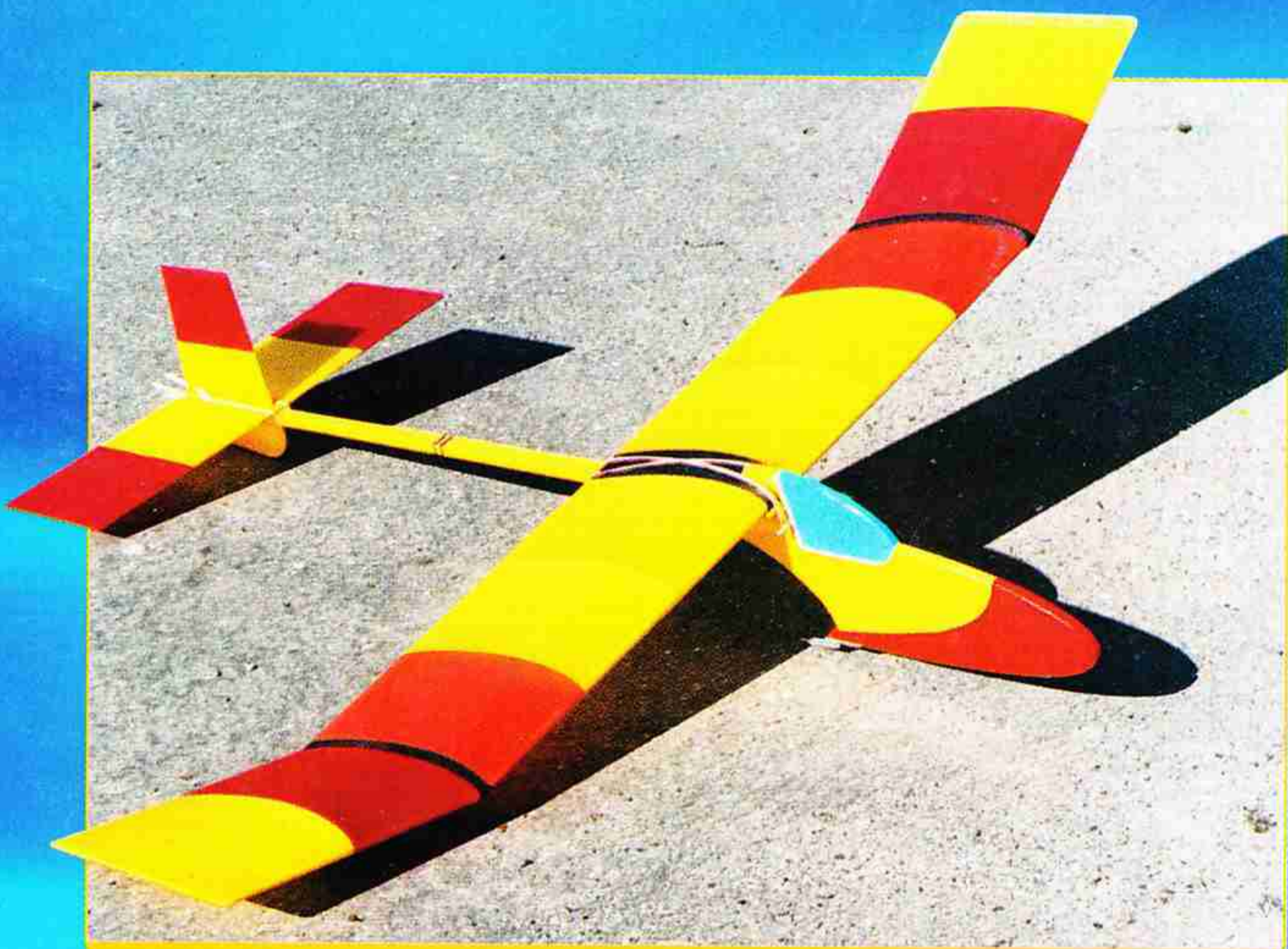
Jiří Plaček z Prahy si postavil pro soutěže historiků v kategorii AV 1 model větroně Šohaj - rozpětí 1100 mm, délka 925 mm, celková plocha 24,8 dm 2 , hmotnost 300 g.
