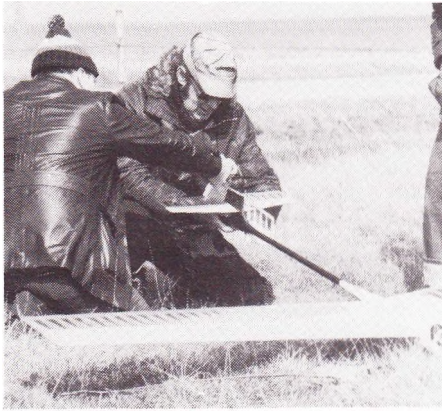
Sagkundskaben vurderer et knækket sideror på en Unica ved en uheldig landing.
