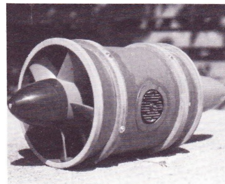
Den færdige ducted fan med motor installeret.
