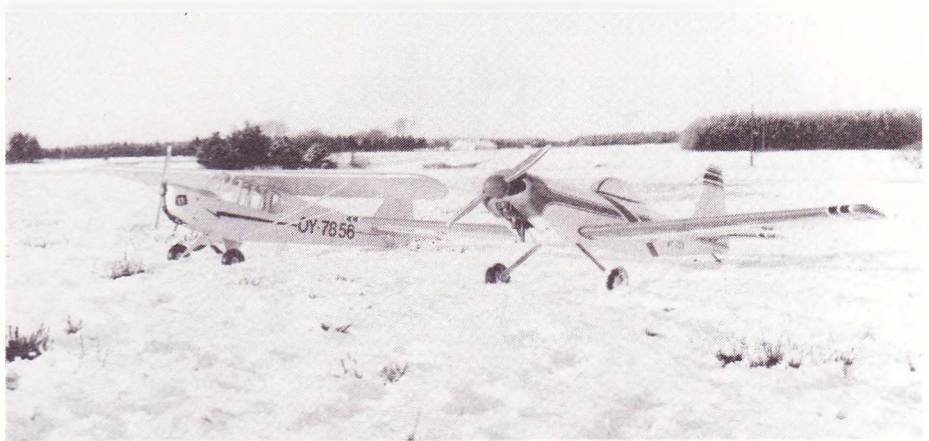
Til venstre i billedet ses Flemming Pedersens Piper Cup J 3 i 1/4 skala. Til højre Ole Mortensens 1/4 skala Akromaster. Piper Cup'en er forsynet med Quadra motor og vejer 8,3 kg, mens Akromaster'en har en Evra med resonansrør til at løfte den 10 kg tunge model.
