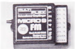
Multiplex Micro 9 modtager 9 kanaler Mål: 51 x 39 x 21 mm Vægt: 42 gram Kanalafst.: 10 kHz Frekvens: FM 27-35-40 MHz
