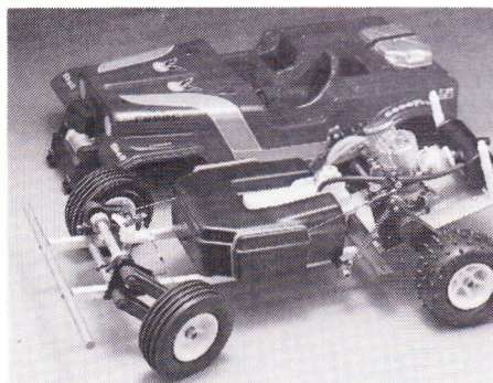
Robbe Romax-Racing Længde 500 mm. Motor 3,5-4 cm 3 , uafhængig hjulaffjedring m. olie- støddæmpere.
