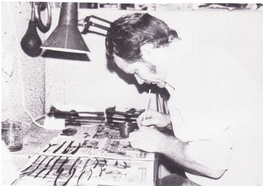
Flemming Jensen i færd med at fremstille en et-bladet propel. Bemærk, at der på aviserne ligger de forskellige længder af carbon-roving klar til ilægning i formen.
