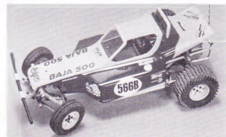
MPX Super Trial 566 B Trial'en har seks hastigheder frem, 1 bak og bremse. Længde 380 mm. Vægt komplet m. anlæg 1.250 g.
