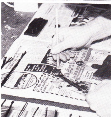
Flemming Jensen i færd med at fremstille en et-bladet propel. Bemærk, at der på aviserne ligger de forskellige længder af carbon-roving klar til ilægning i formen.
