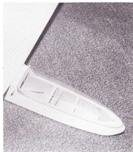
Her ses den næsten færdige Filius — og til højre ser man, hvordan der er sørget for god plads til RC-anlægget i modellens næse.
