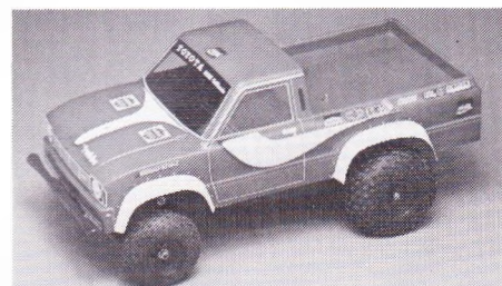
Robbe Toyota Hilux Længde 410 mm. Motor Mabuchi 540 S. Kobling, gearkasse og fartregulator.
