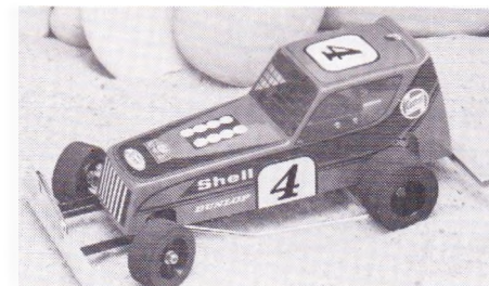
Robbe Desperado Længde 300 mm. Motor Mabuchi 540 S og trinløs fartregulator frem og bak.
