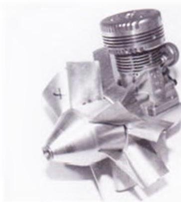
O.S. 77 monteret med rotor og stator.
