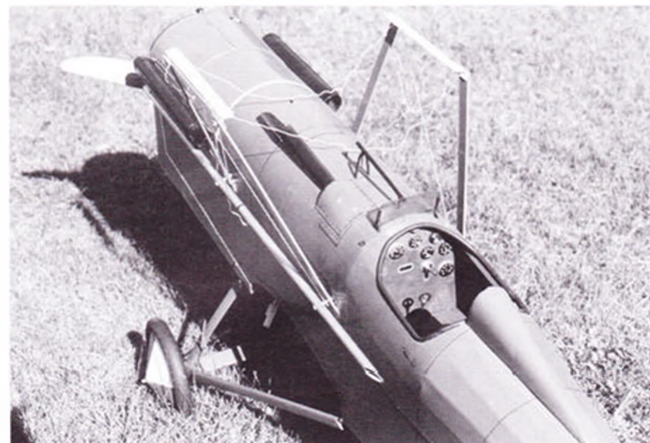
Motorrummet åbnes som på en veteranbil. Lukketøjet er almindelige gummibånd, og hele låget holdes på plads af en langsgående fjeder.
