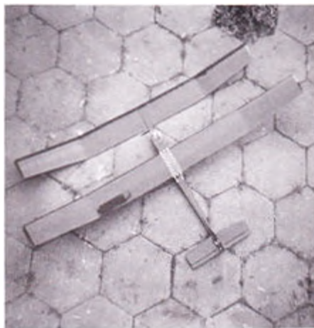
Blue Phoenix med forlængt vinge set i forhold til originalvingen.
