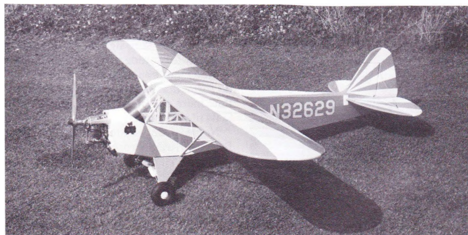
Kunstflyvningstræner beklædt med Solartex og pyntet med selvklæbende folie fra farvehandleren.
