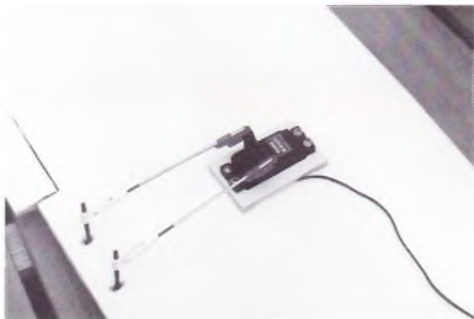
Krængerorsservoer. V-formen på servohornene giver en vis differentiering, dvs. større udslag opad end nedad.
