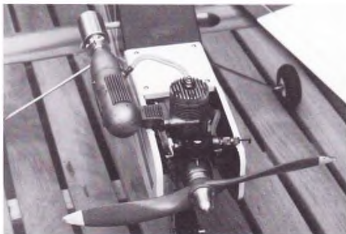
En Irvine .46 på det fiks motorfundament. "Mouse" efterdæmperen bringer støjen ned på et acceptabelt niveau.
