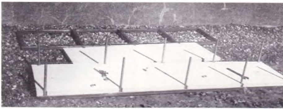
Jørgen Nielsens udgave af en vingepresse. Det hele bliver lagt ned over de lange, strittende bolte og spændt sammen.
