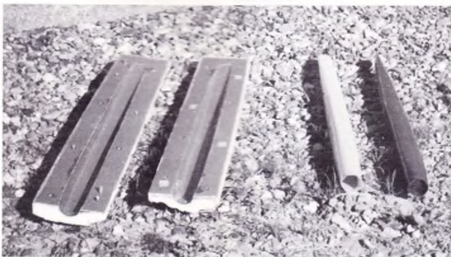
De to dele af formen til kroppen sammen med to afstøbninger.
