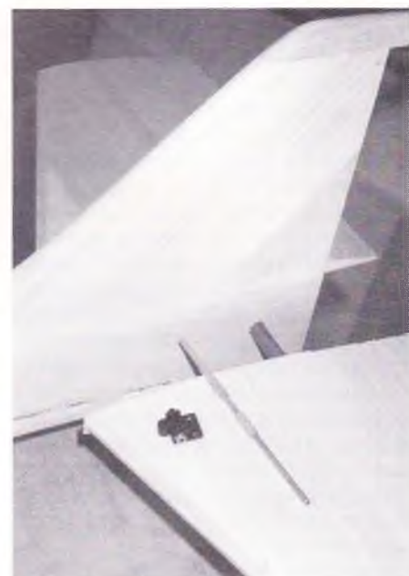
Erik Tofts Jester under bygning. På billedet ses halemonterings- og justeringsbeslag.
