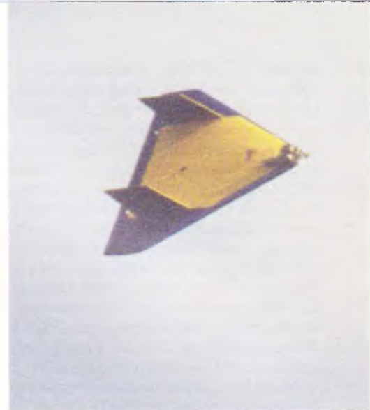
Laser Arrow i en lav forbiflyvning. Det er absolut nødvendigt med en stor forskel på farverne på overside og underside.
