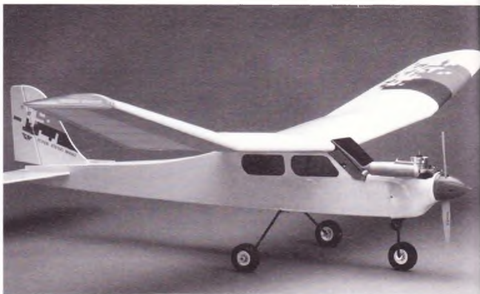
Blandt fordelene ved "El å Stick" er, at motoren er billig, og så er den nem at komme til.
