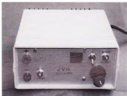
En lader i den lidt dyrere ende. JVH laderen er købt for ca. 1000 kr., men kan så lade et batteri med op til 21 celler på en gang.
