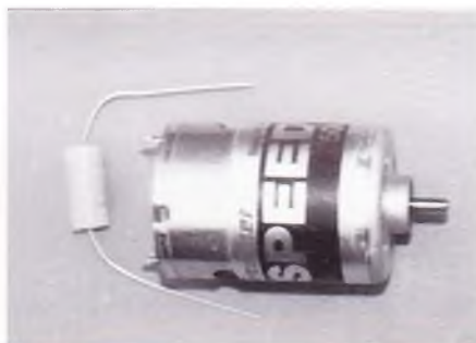
En kondensator forbundet med plus og minus sænker det elektroniske støjniveau.
