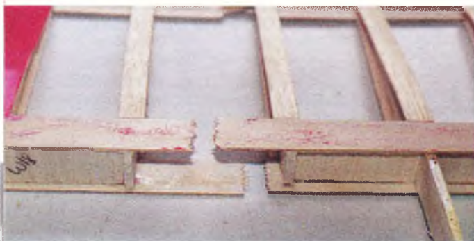
Nærbillede af de forholdsvis "rene" brud på hovedlisten.
