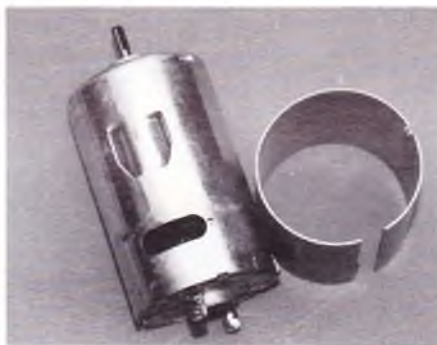
Nogle motorer leveres med en statorring. Det er en jernring, der monteres rundt om motoren ud for magneterne, og som forbedrer motorens ydelse en smule.
