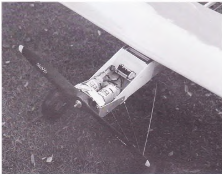
De to Speed700 motorer, gear, hjemmebygget fartregulator og 20x10 propel.
