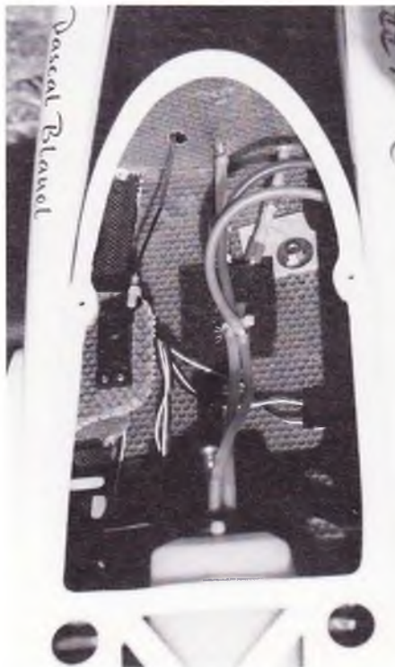
I vid udstrækning bruges nye honey-comb-materialer til bl.a. spanter. Her er det i en glasfiber-udgave
