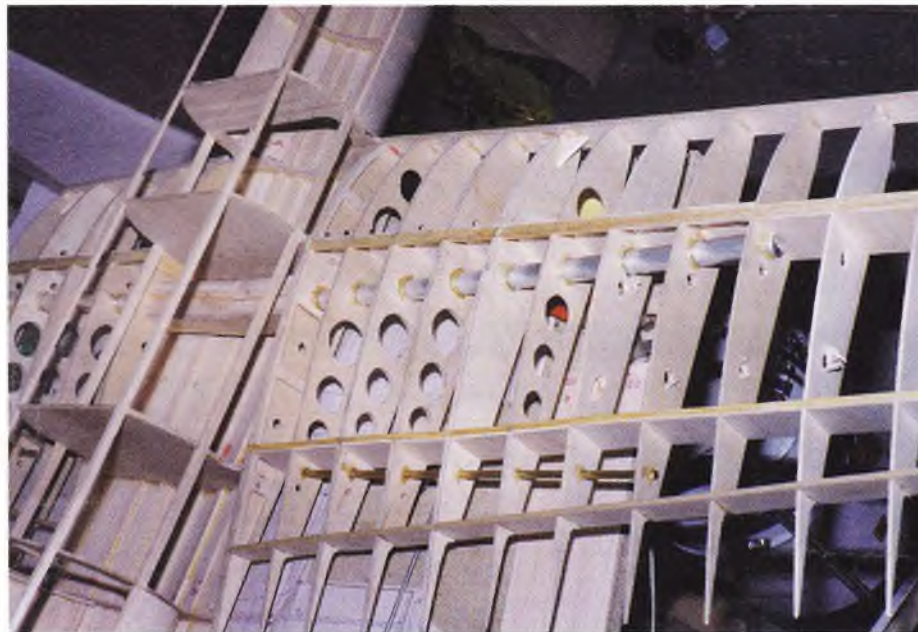
Et kig på det store arbejde, der ligger i at bygge en ribbevinge og en spantekrop.
