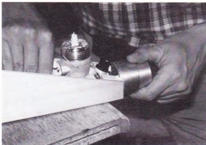
Tilpasning af forkrop til spinner.
