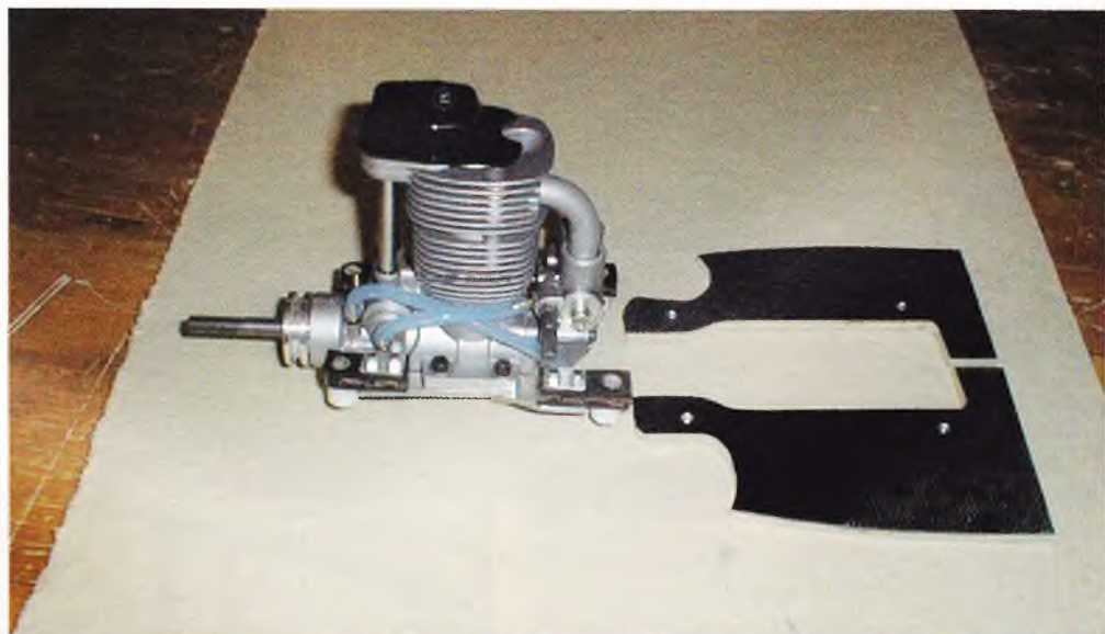
Motoren er en YS 140 FZ med hjemmelavet gummiophæng sammen med motorpladen.
