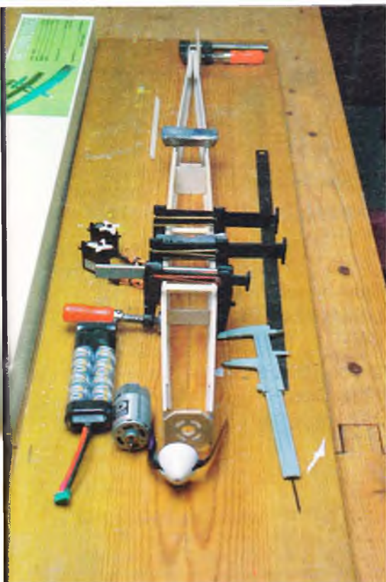
Kroppen samles på byggebrættet. Motorspanet er reduceret i højde og bredde, og der er udskåret kølehuller til motoren. Jeg har kontrolleret, at der er plads til motoren, og at det er muligt at udskifte batteriet.
