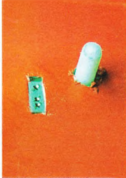
Montering og forbindelse mellem vinge og krop.
