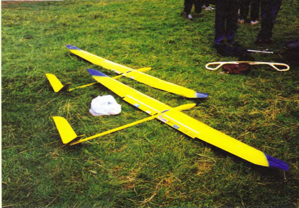
Det tyske fly Starlight, der har en spændvidde på 3200 mm og profilet MH 32. På dette billede kan man se de ret store flaps, der giver en ekseptionel god bremsevirkning, når de sættes ned i 80-90°, og krængerorene hæves 10-15°. Bemærk også den ret lange bagkrop, der er speciel for dette fly. En anden bemærkelsesværdig ting er, at der selv i de opadbøjede tipper er krængeror, og når det hele mixes i en moderne radio, kan hele bagkanten bruges som flaps i både højstarten og under flyvningen.
