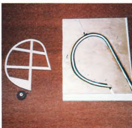
Halefinnen med den i teksten omtalte byggeskablon.
