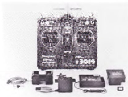
T3014 FMSS Exzellent (FM) kr. 1.995,-?? Max. 7 servoer. Udskifteligt sender- modul. Til 27, 35 el. 40 MHz. Dual-rate, mixerfunktion. servoomskiftning mm.
