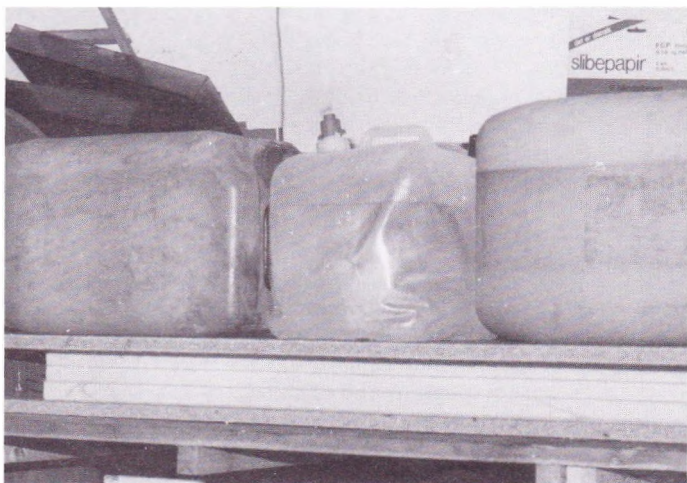
Foto 11: Hele vingebløkken, sikret mod skred med knappenåle, ses her i spænd mellem de to presseplader og med vanddunke ovenpå. Pressevægten er ialt ca. 50 kg, som er fordelt jævnt over hele vingebløkken.
