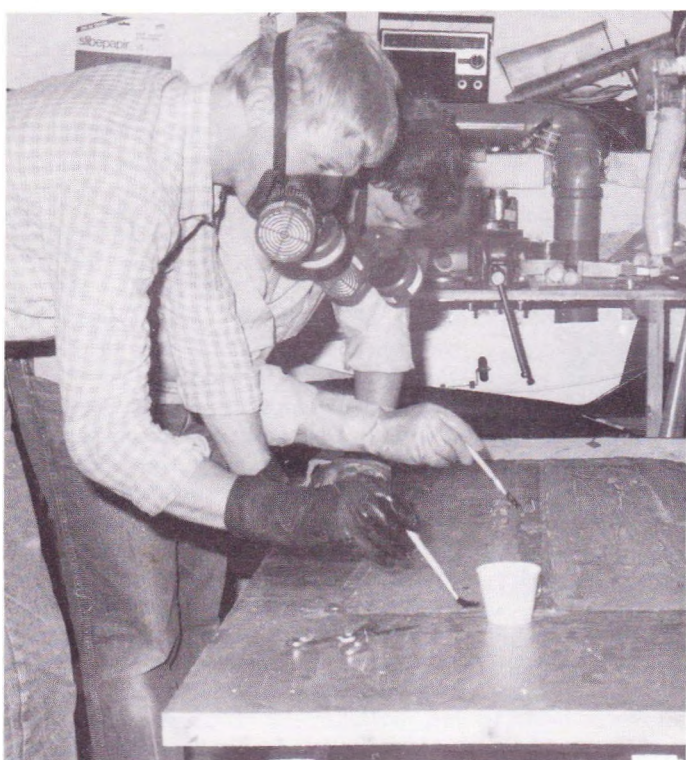
Foto 7: Epoxien fordeles på plastikfolien, og vævet lægges herpå lag for lag.
