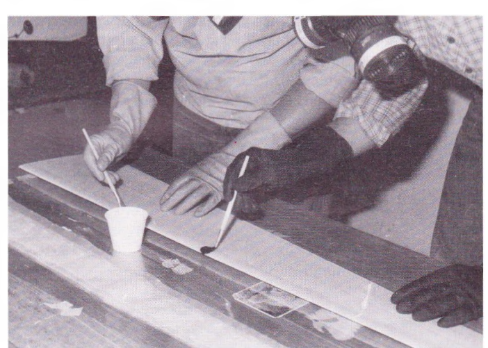
Foto 6 A: Der smøres epoxy på skumkærnernes forkant, og vævet lægges på lag for lag. Et nyt lag når det foregående er godt gennemvædet og »trukket« til skumkærnen.
