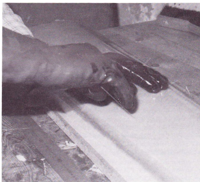
Foto 10: Fra midten af vingen skubbes med en spartel i hele vingen længde ud mod henholdsvis for- og bagkanten overskydende epoxy. Herved fyldes de to kanter op med epoxy. Samtidig trykkes vævet mod skumkærnen og eventuelle luftbobler »skubbes« ud.
