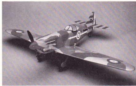
Dewoitine D.520 , spv. 1.290 mm, til 4 cm 3 motor ..... kr. 420,- Messerschmidt ME 109 og Dewoitine D.520 kan ombygges til linestyring. Delene hertil findes i byggesættet.
