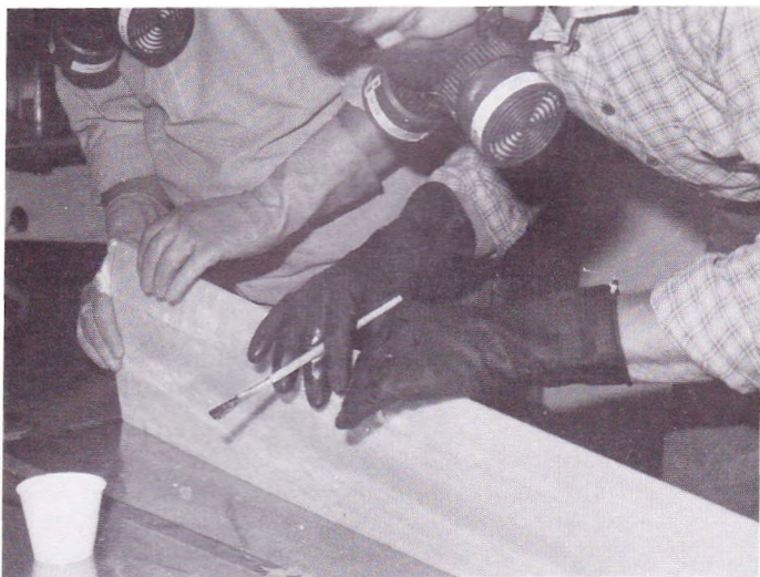
Foto 6 B: Vævet pensles og trykkes med fingrene fast mod skumkærnsens forkant, så det slutter både på over- og underside af vingen. Vingen stilles nu til side for at »trække«, indtil den skal lægges sammen med de to folielag.
