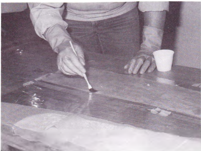
Foto 8: Der lægges først et nyt lag væv på folien, når det foregående er gennemvædet og rullet eller duppet fast på folien.
