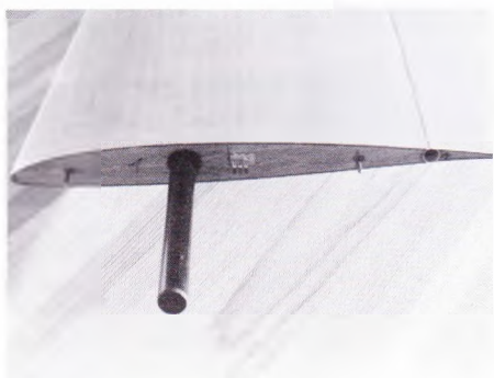
På billedet herover ses det ene »øre« med isat kulfiberstang, og til højre ses anbringelsen af krængerors-servoen i »øret«.
