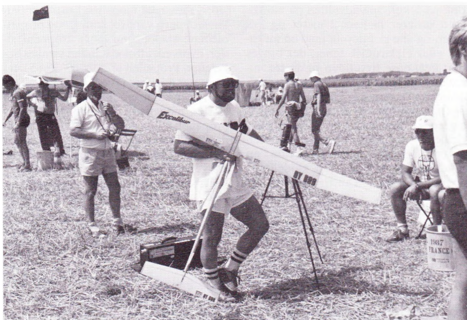
Moderne kunststof-gasmotormodel. Der er ingen træmaterialer i modellen, men derimod Kevlar, glas- og kulfiber samt Rohacell skumplastic.
