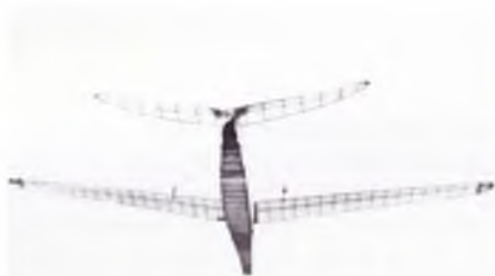
Gummimotormodel i canard konfiguration (andemodell) fra 1940. (OM-Fs arkiv)
