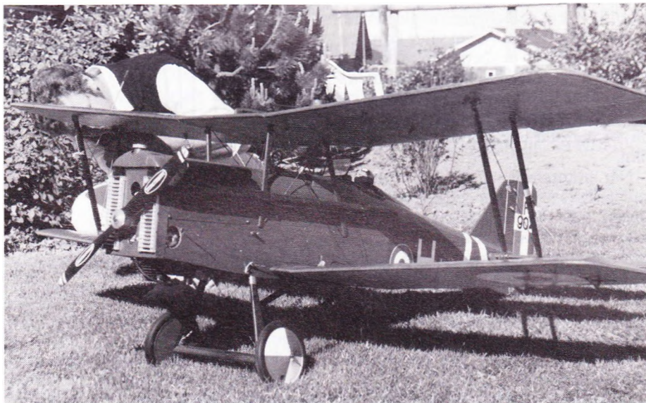
Chr. Manly i gang med at klargøre sin SE 5A. På siden af den ses det hul, som det var nødvendigt at lave for at skaffe plads til den større motor.
